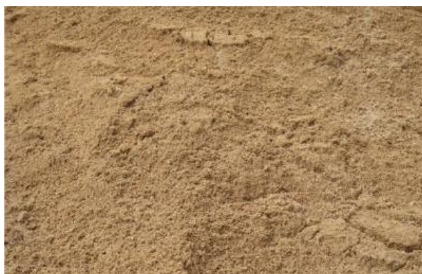
Obrázek č. 1.1.2-Písek maltový, frakce 0-1, použití: maltové omítky
