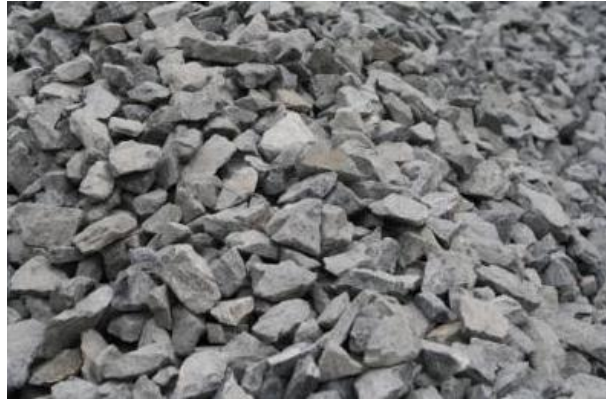
Obrázek č. 1.1.8-Drt', frakce 16-32, použití: beton a podkladový materiál
