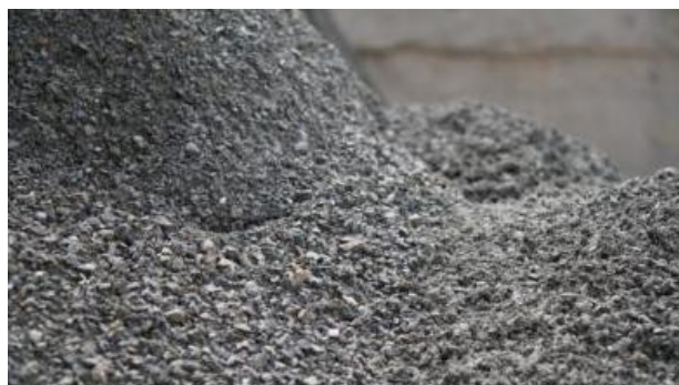
Obrázek č. 1.1.10-Drt', frakce 0-4, použití: podkladové vrstvy, zásypy inženýrských sítí
