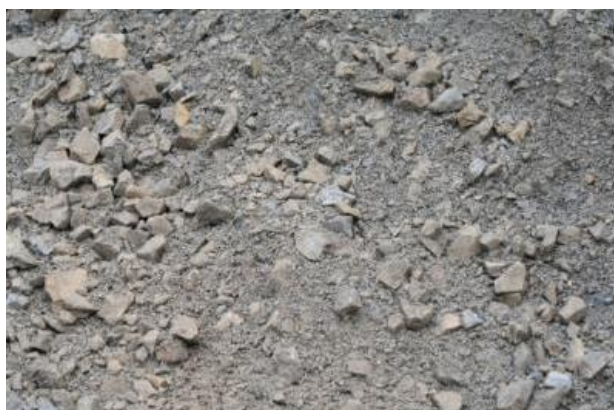
Obrázek č. 1.1.12-Drt', frakce 0-63, použití: podkladové vrstvy komunikací
