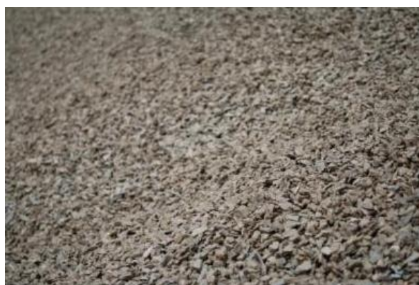
Obrázek č. 1.1.6-Drt', frakce 4-8, použití: beton a podkladový materiál
