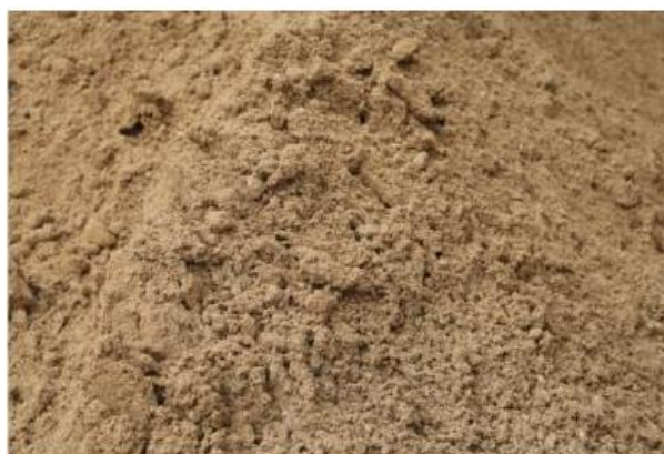
Obrázek č. 1.1.3-Písek tříděný zásypový, frakce 0-8, použití: zásypy potrubí a el. vedení
