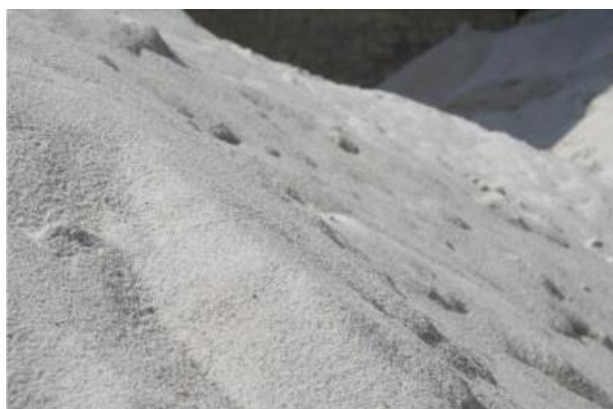
Obrázek č. 1.1.1-Písek slévárenský PR 30/31bílý, frakce 0-2, použití-betony, štuky, prosyp dlažby
