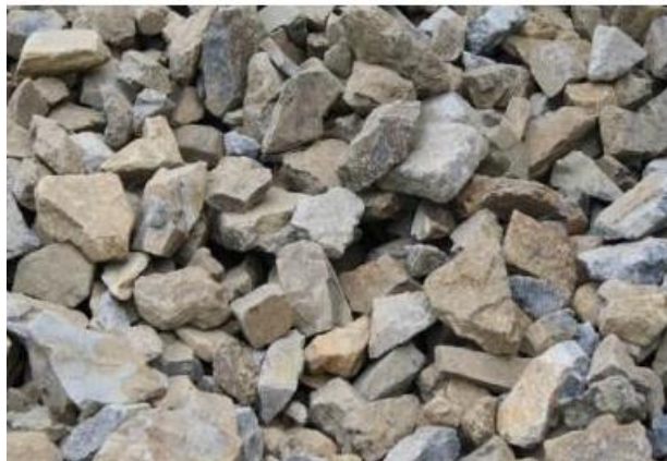
Obrázek č. 1.1.9-Drt', frakce 32-63, použití: podkladové vrstvy komunikací
