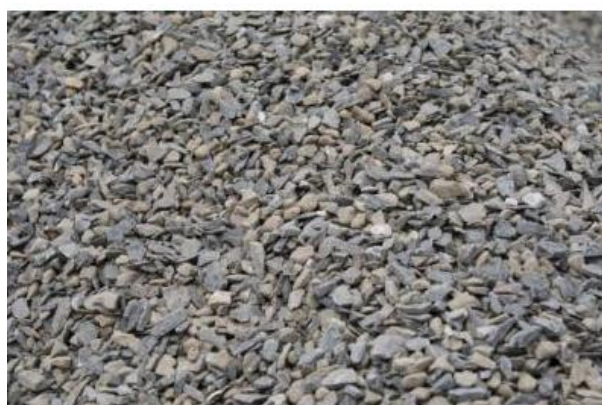
Obrázek č. 1.1.7-Drt', frakce 8-16, použití: beton a podkladový materiál
