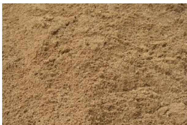
Obrázek č. 1.1.4-Písek betonářský, frakce 0-4, použití: betony a betonářské výrobky
