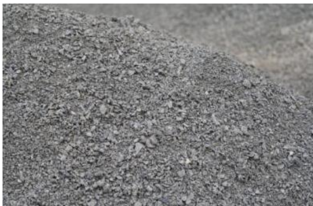
Obrázek č. 1.1.11-Drt', frakce: 0-32, použití: podkladové vrstvy komunikací
