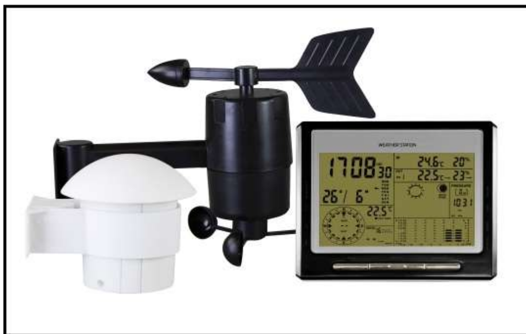
4.3.4.1 obr. č. 7 - Meteorologická stanice KL4900
