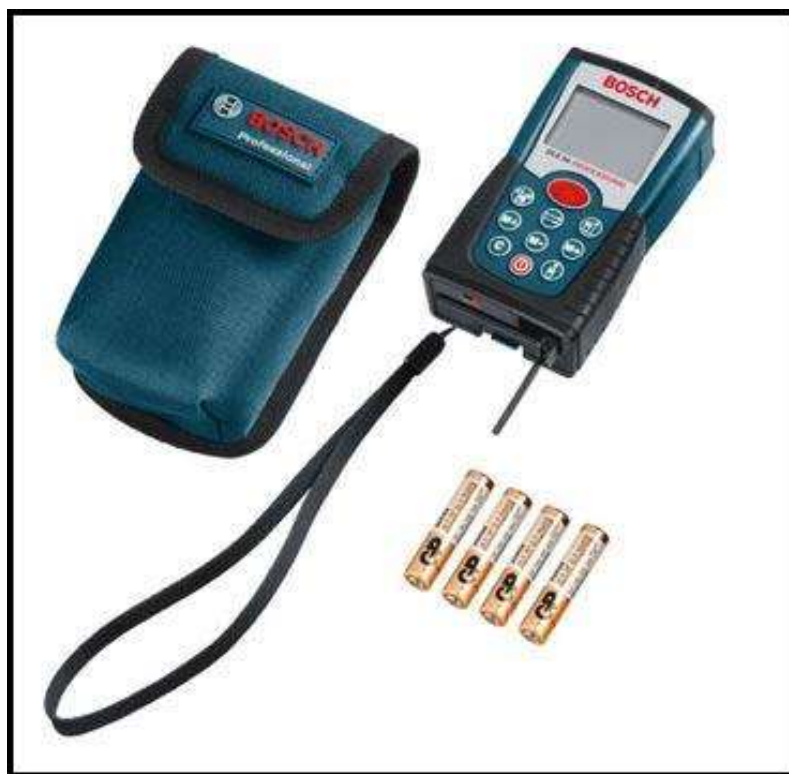
4.3.3.1 obr. č. 6 - Laserový měřič vzdáleností Bosch DLE 50
