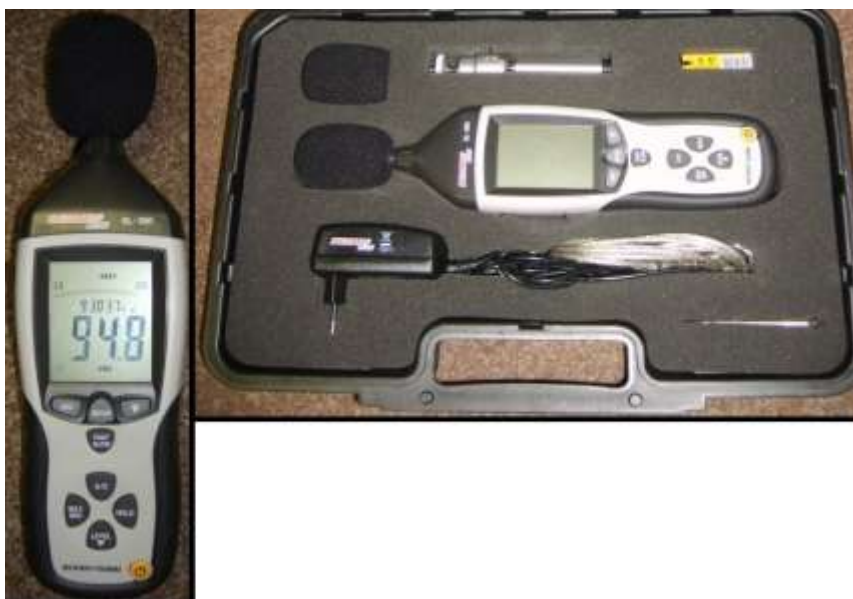
4.3.1.1 obr. č. 4 - Digitální hlukoměr Voltcraft Plus SL-300
