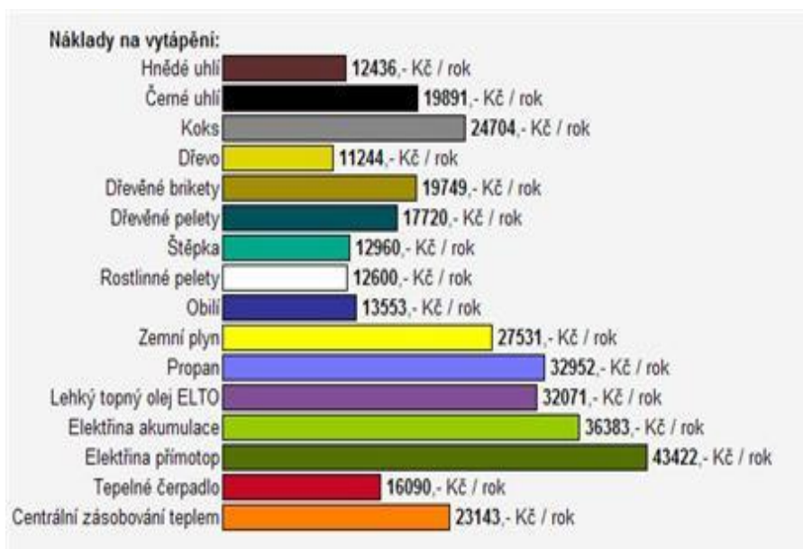
Graf: Náklady na vytápění: modelová situace (spotřeba tepla 65 GJ/18 kWh) (zdroj: www.energ.cz, 2011)
