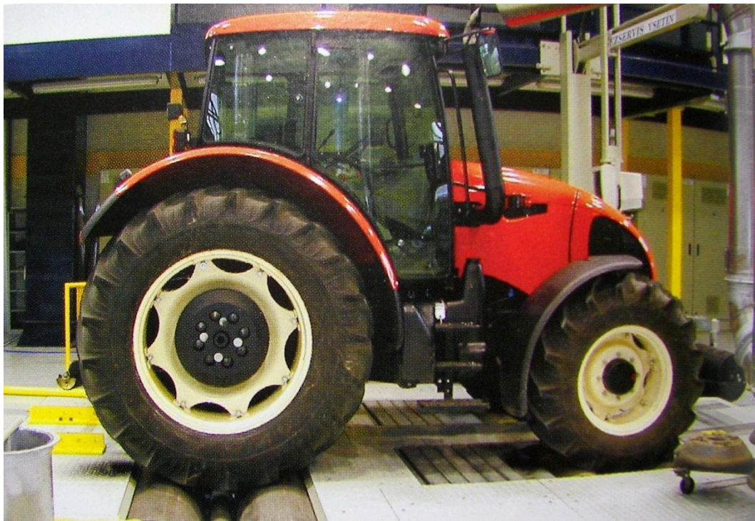
Obr. 2.6. Traktor Zetor na válcovém dynamometru v laboratořích MZLU v Brně
