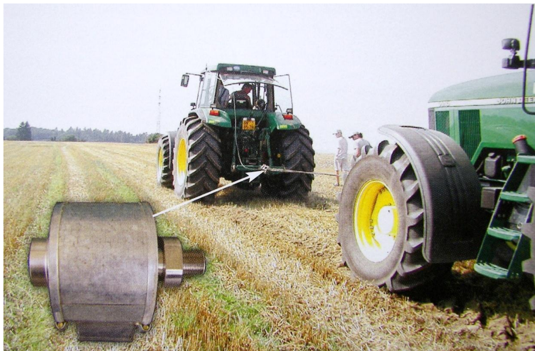
Obr. 2.1. Měření tahové charakteristiky traktoru na strništi
