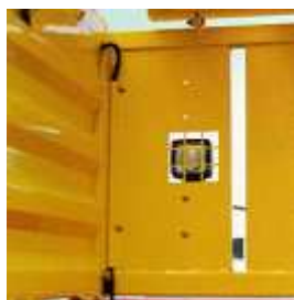
Obrázek 3 – Pracovní světlo na přední stěně zajišťuje dostatečné osvětlení ložného prostoru.
