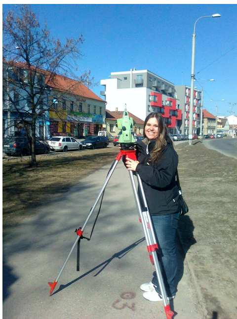
Obr. 7.2 měření s totální stanicí Leica TCR 407 Power
