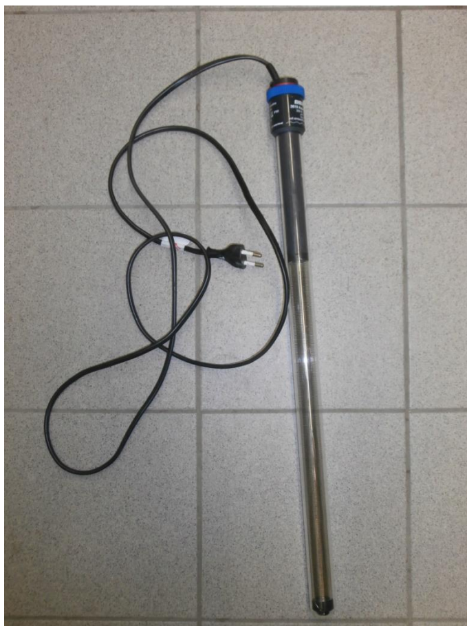
Obrázek 12: Topné těleso Eheim Jäger o výkonu 300 W (foto – autor).
