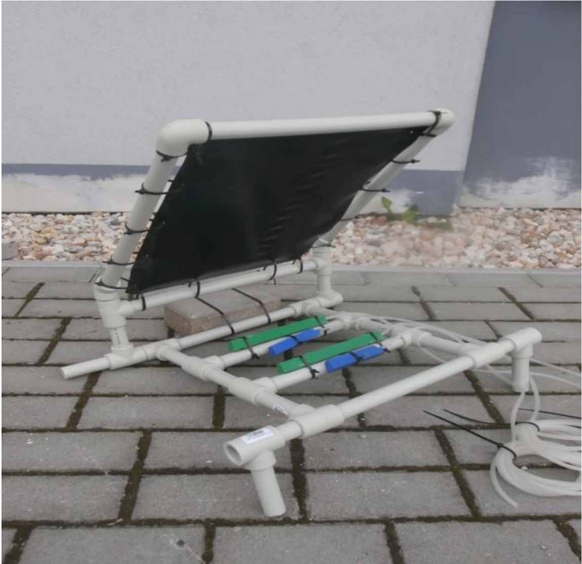
Obrázek 10: Zkonstruovaný airlift pro zajištění aerace a pohybu vody v BFT (foto – autor).
