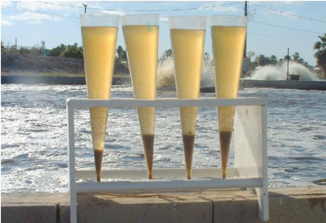
Obrázek 5: Imhoffovy konusy pro měření množství nerozpuštěných látek a zjišťování přítomnosti vloček v nádrži (Avnimelech, 2012).
