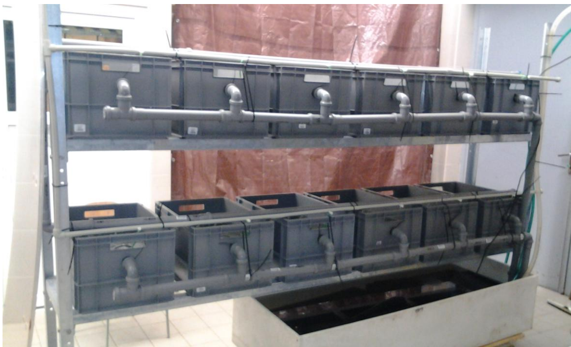
Obr. 8 Recirkulační systém ze zadní strany, pod odchovnými nádržemi je umístěna odtoková nádrž s filtračním materiálem a čerpadlem.
