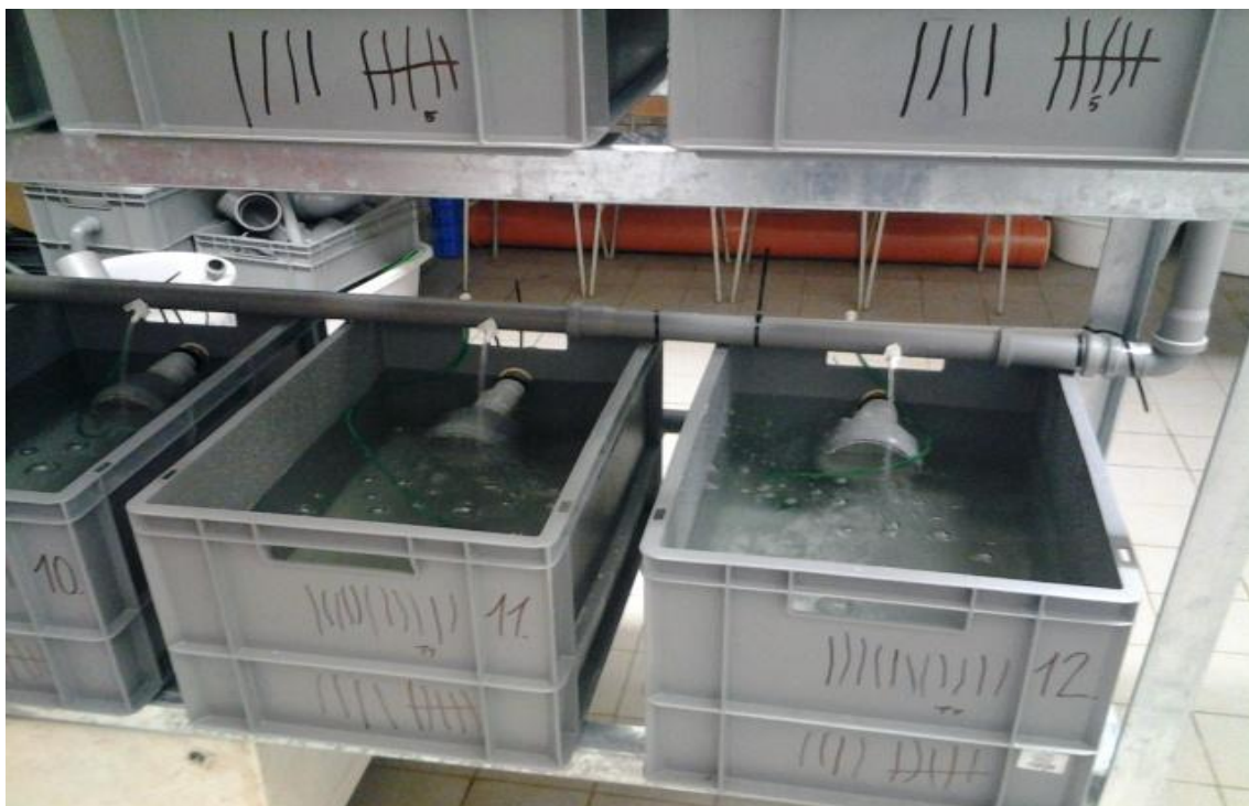
Obr. 7 Odchovné nádrže, pohled shora, detail přítoku i odtoku vody
