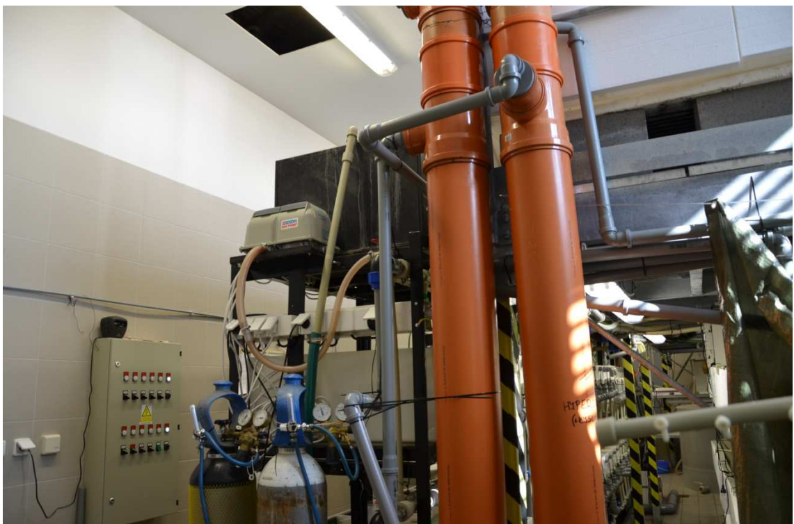
Obr. č. 6. Pohled na směšovače vody s kyslíkem vlastní konstrukce, tlakové lahve s kapalným O_2 a N_2 a systém regulace.
