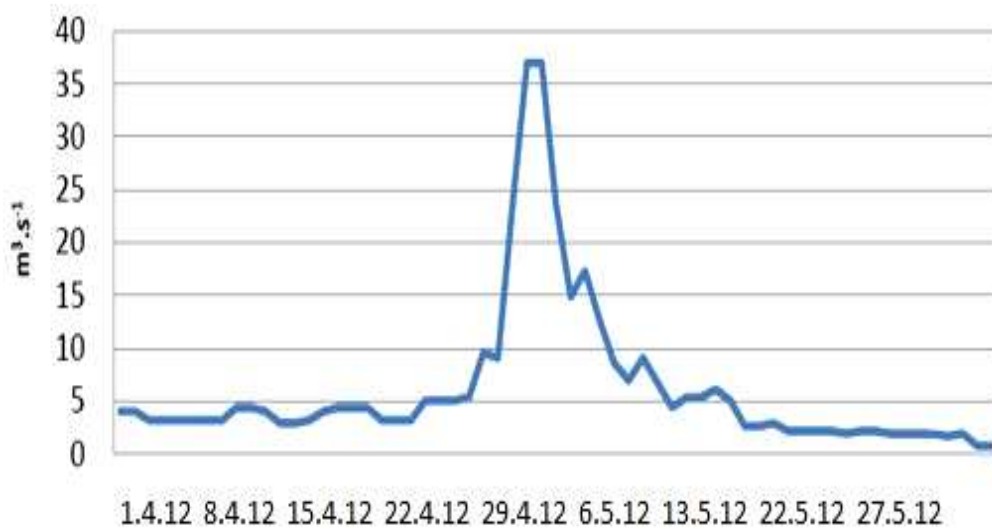
Obrázek 12. Kolísání průtoku vody v horním Labi během přirozené jarní povodně na přelomu dubna a května 2012 (podle Povodí Labe, s.p.).
