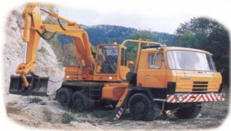
Obrázek 16: rypadlo umístěné na podvozku automobilu bez teleskopického výložníku
