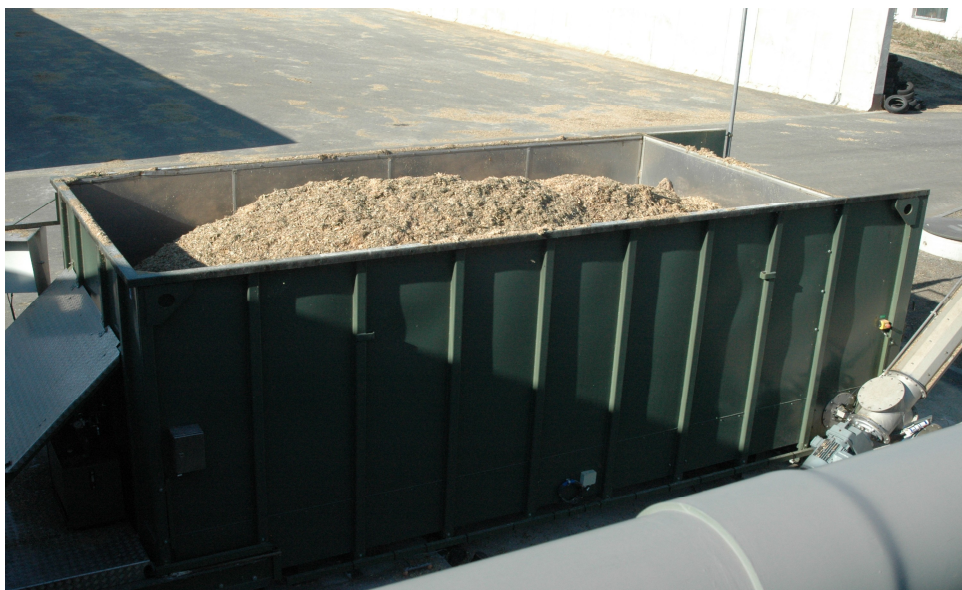
Obr. č. 10: Dávkovacími zařízení na pevné substráty BPS Třeboň pohled z fermentoru (Zdroj: Zajíc, 2012)
