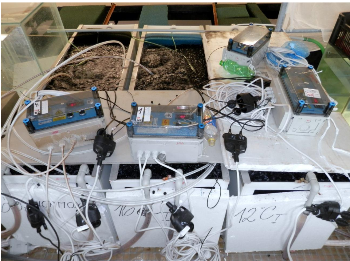
Příloha 4: Biologické filtry vyplněné fluidním médiem spolu s řídicími jednotkami hlídajícími stálou teplotu vody (18 °C).
