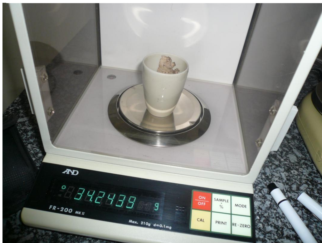
Příloha č. 9: Zbytkový vzorek v kelímku vážený na analytických vahách.
