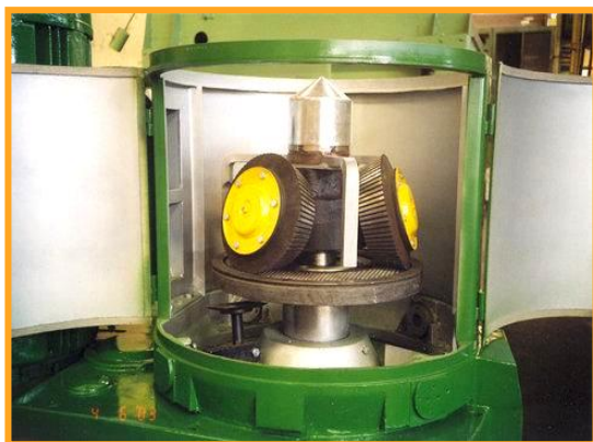
Obr. č. 8 – Lis s taliřovou maticí – Zdroj: http://www.ateap.cz/
