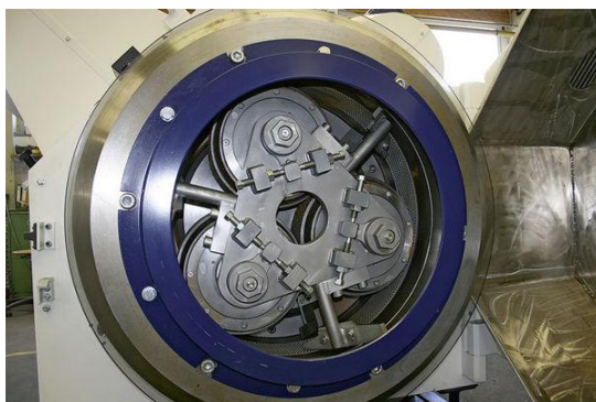
Obr. č. 7 – Lis s prstencovou maticí – Zdroj: http://www.timber-online.net/?id=2500,5062927,
