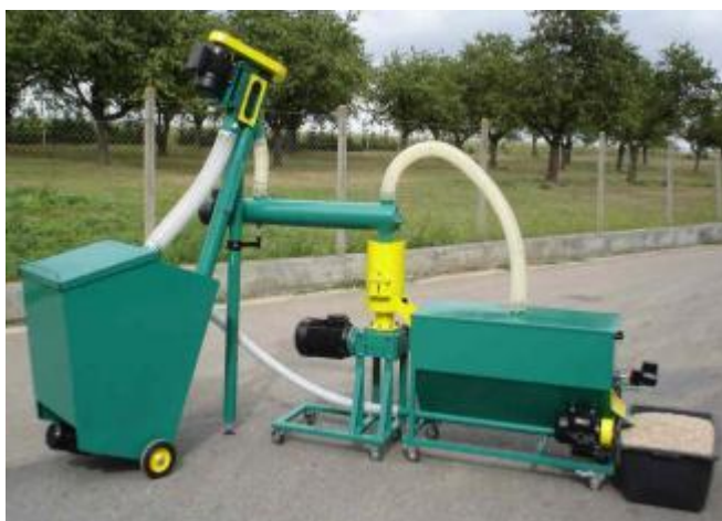
Obr. č. 10: Provozní stav peletovací linky MGL 200 – Zdroj: http://www.kovonovak.cz/mala-granulacni-linka
