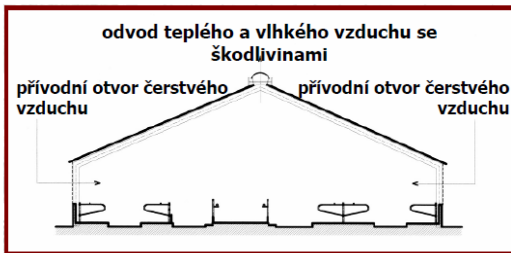
Obrázek č. 1 Schéma přirozeného větrání ve stáji
