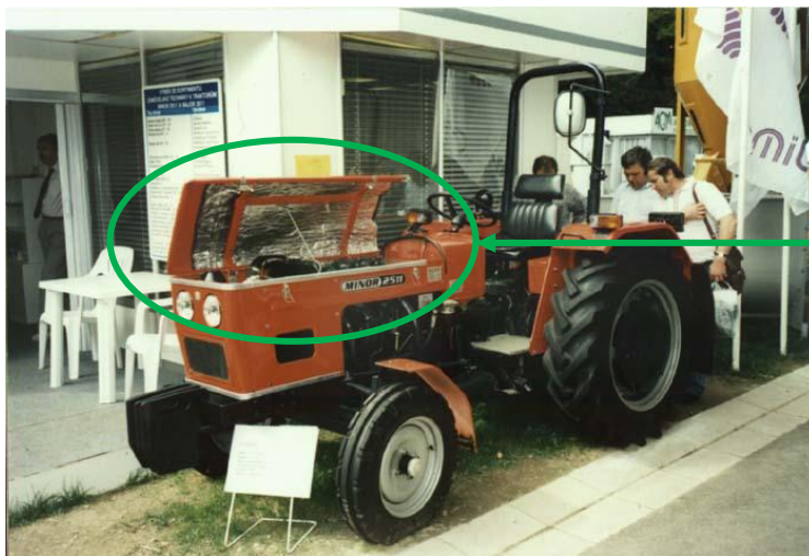
Obrázek 38 - Příklad využití sendvičového materiálu při odhlučnění motoru malého traktoru. [10]
