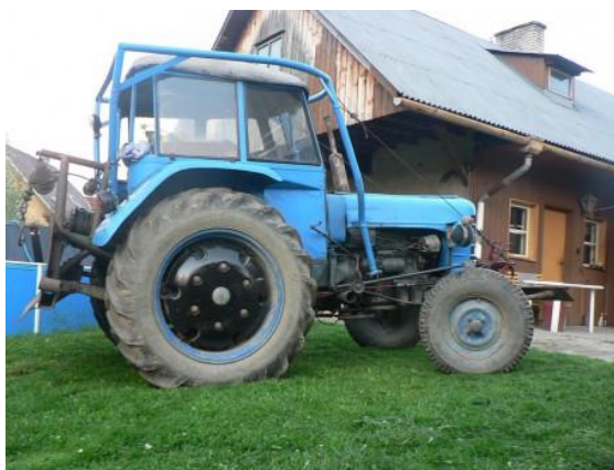
Obrázek 13 - Polouzavřená kabina s ochranným rámem Zetoru 3011 < http://www.trak-zet.estranky.cz/fotoalbum/nase-technika/zetor-3011/lesni-nstavba.html >
