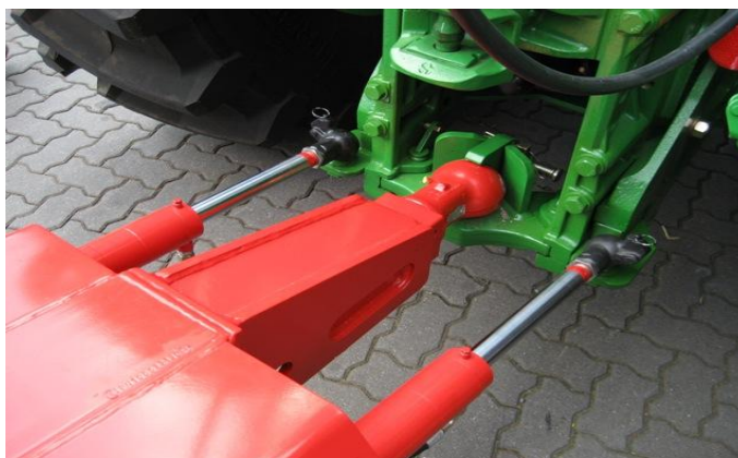
Obrázek 9. Systém nuceného řízení nápravy (zdroj: www.crs-marketing.cz )
