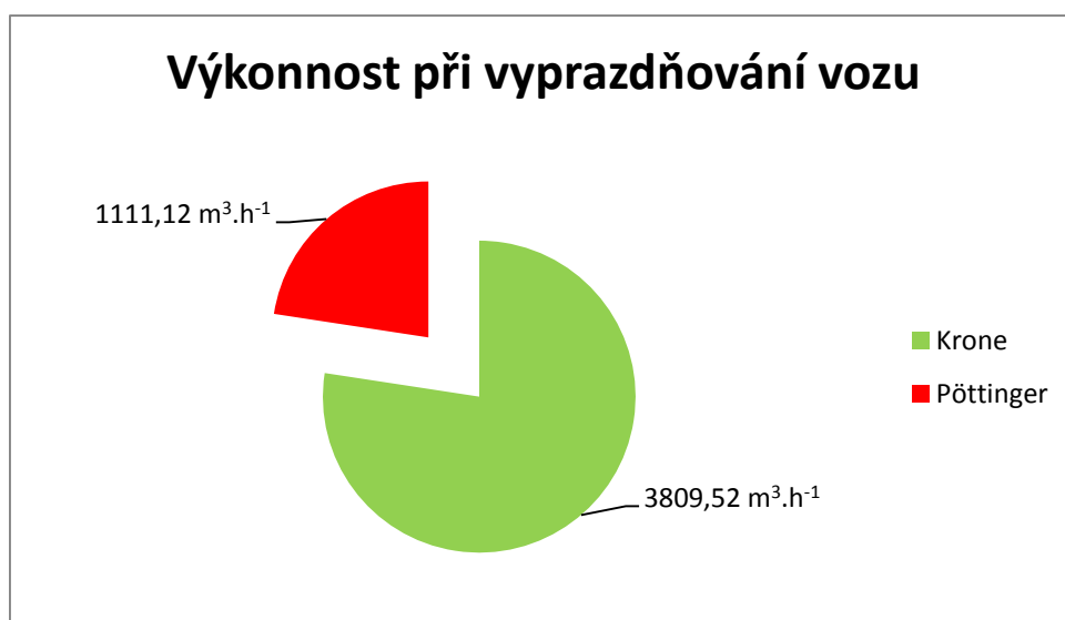
Graf 8. Vyprazdňovací výkonnost při sklizni slámy u vozu Pöttinger Faro 8000 a Krone Titan R80/GL
