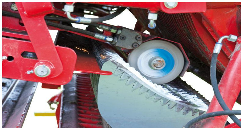
Obrázek 14. Autocut – broušení nožů přímo na senážním voze (zdroj: www.pottinger.cz )
