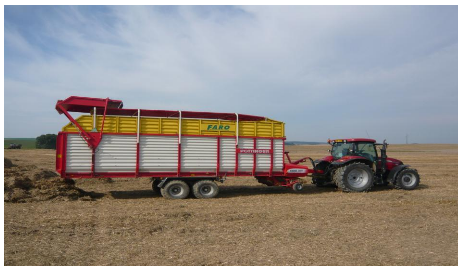
Obrázek 19. Traktoru Case IH MXU 135 Pro v agregaci se sběracím vozem Pöttinger Faro 8000
