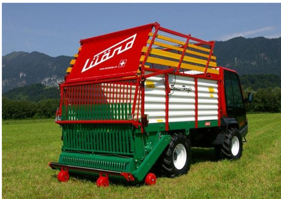
Obrázek 4. Samojízdný sběrací vůz značky Lindner se sběracím ústrojím umístěným v zadní části (zdroj: www.lindner-traktoren.at )
