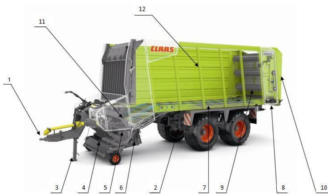
Obrázek 6. Celkový pohled na traktorový sběrací návěs s rozpojovacími bubny značky Claas: 1 - závěs, 2 - rám s pojezdovou nápravou, 3 - opěrná noha, 4 - sběrací ústrojí, 5 - nakládací ústrojí, 6 - řezací ústrojí, 7 - příčný podlahový dopravník, 8 - hydromotor, 9 - frézovací válce, 10 - výklopné zadní čelo, 11 - kanál, 12 - nástavba (zdroj: www.agrall.cz )
