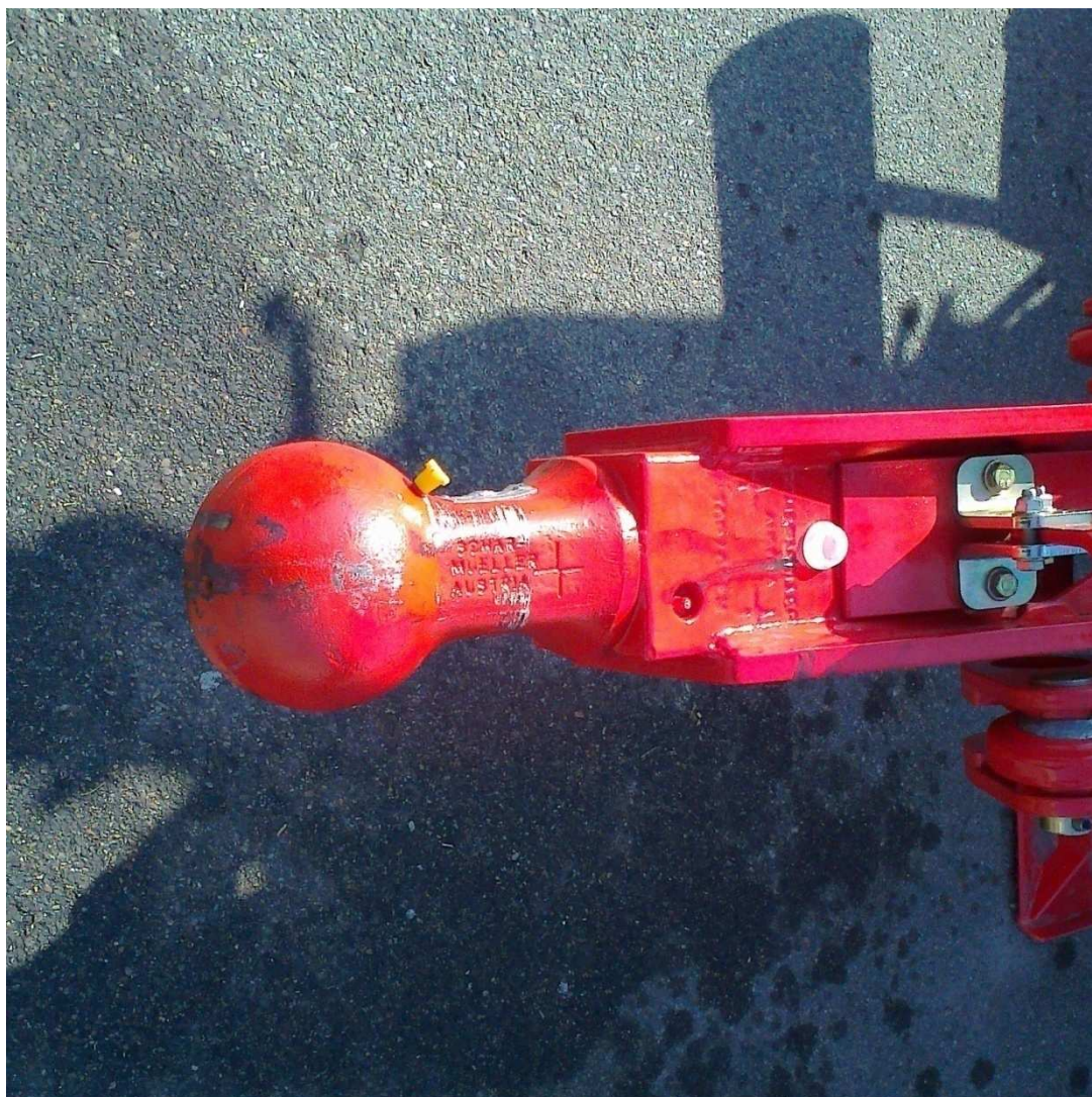
Obrázek 2 – Závěs sběracího vozu
