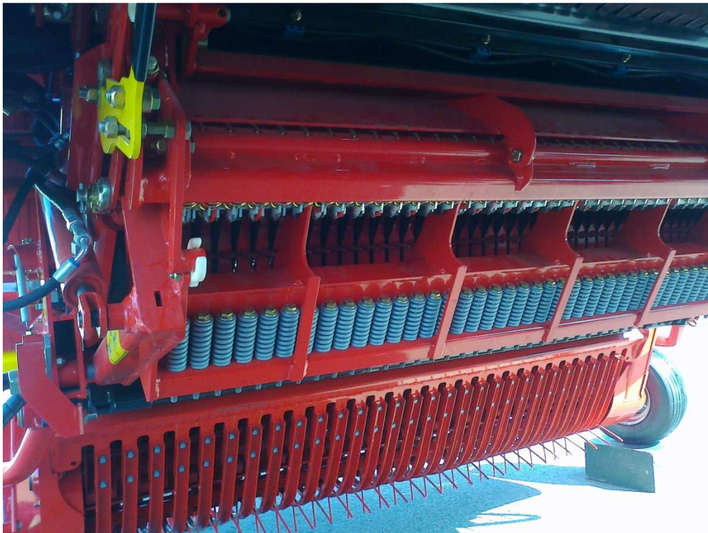
Obrázek 6 – Uložení nosníku nožů u Pöttinger Jumbo 10010 Combilline
