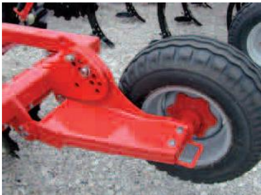
Obr. č. 14 Opěrná kola
