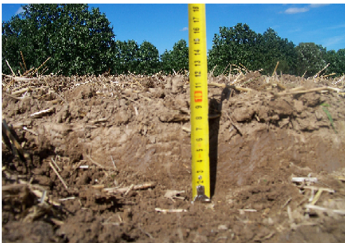
Obr. č. 28 Měření hloubky zpracování půdy HORSCH Joker 8 RT
