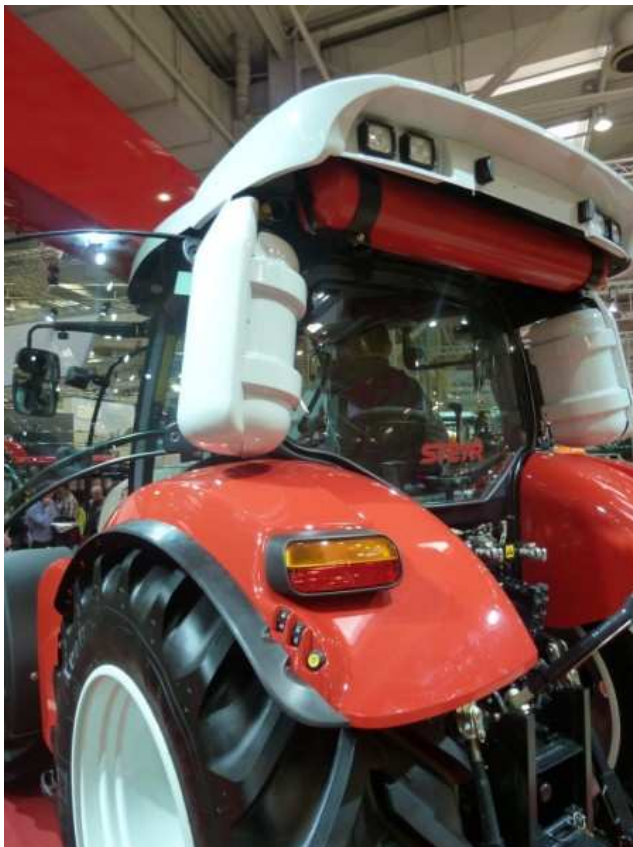
Obr. č. 8.6 Traktor Steyr Profi 4135 Natural Power – částečný pohled na umístění tlakových nádrží CNG
