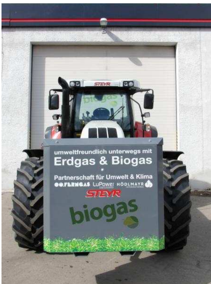
Obr. č. 8.3 Traktor Steyr 6195 CVT s mobilním nosičem CNG tlakových lahví na předním tříbodovém závěsu
