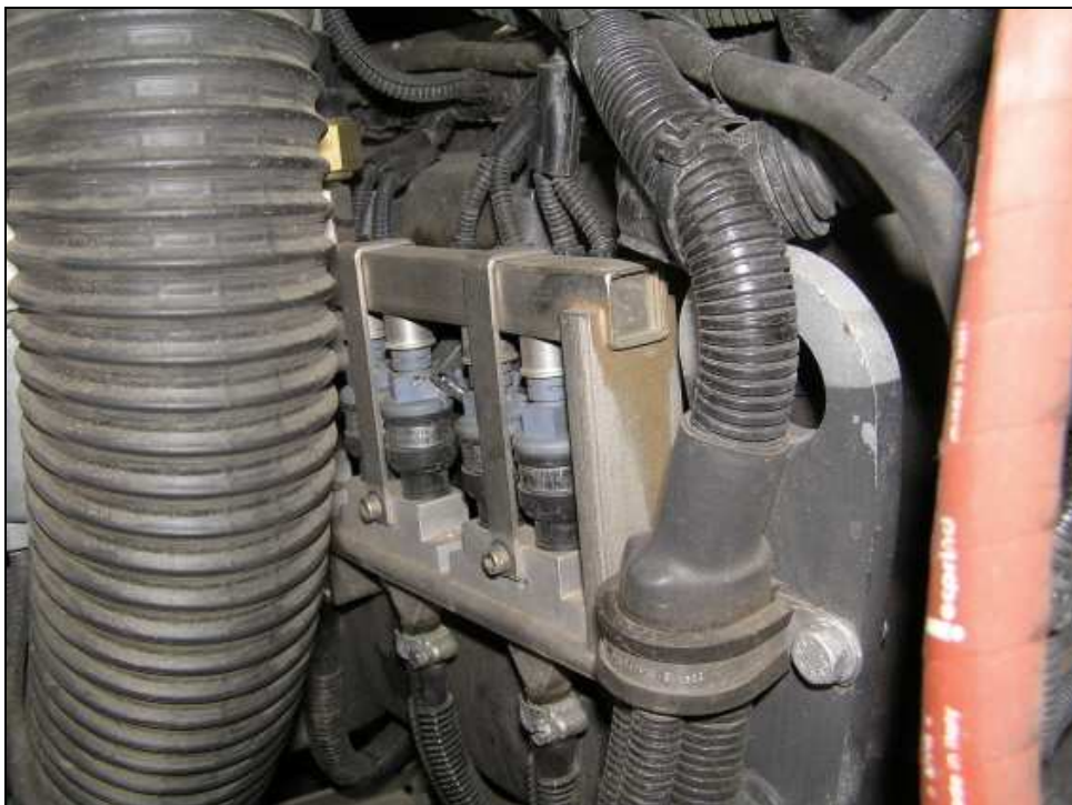
Obr. č. 7.4 Vstřikovací trysky CNG autobusu
