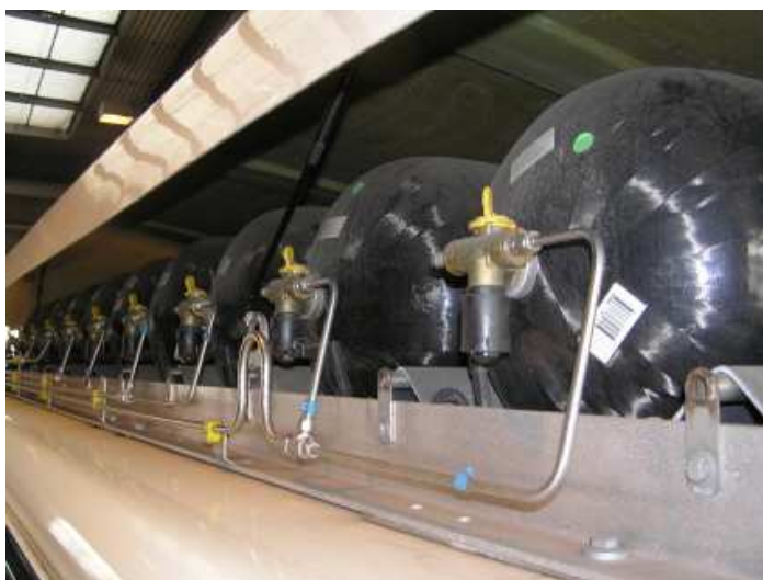
Obr. č.7.1 Tlakové nádrže CNG autobusu umístěné na střeše vozidla
