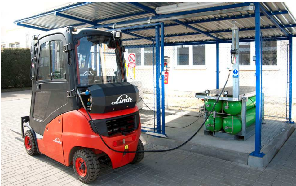
Obr. č. 10.1 Plnění vysokozdvížného vozíku LINDE H20 v areálu firmy MOTOR JIKOV STROJÍRENSKÁ a.s.
