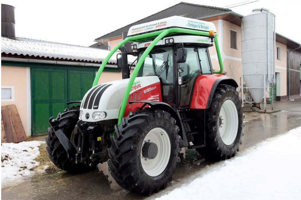
Obr. č. 8.4 Traktor Steyr 6195 CVT se speciální nástavbou nosiče CNG tlakových lahví na střeše
