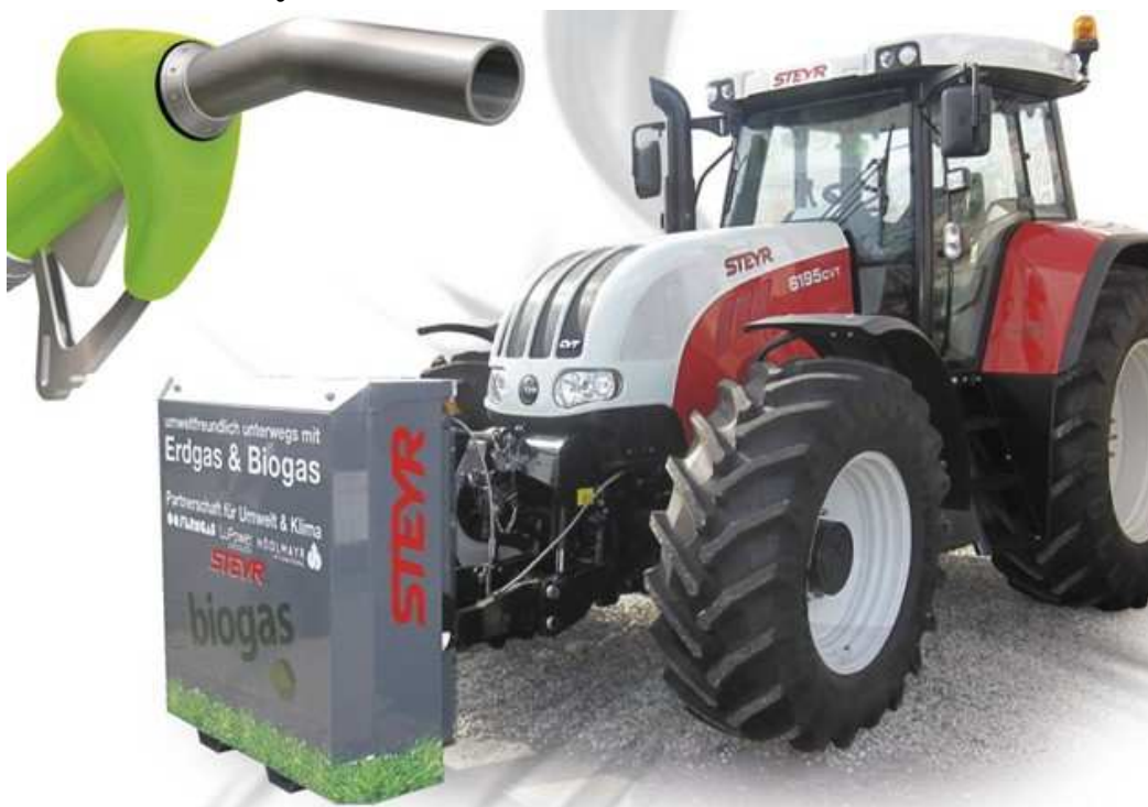
Obr. č. 8.1 Traktor Steyr 6195 CVT s mobilním nosičem CNG tlakových lahví na předním tříbodovém závěsu
