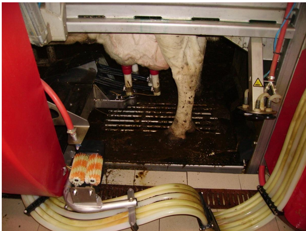
Obrázek č. 5: Pohled na kartáče a dojící násadce při dojení
