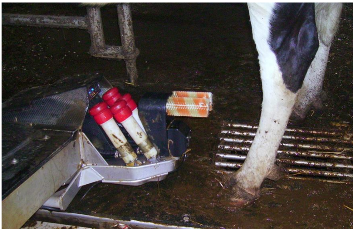
Obrázek č. 3: Pohled na kartáčky k očištění a stimulaci struků
