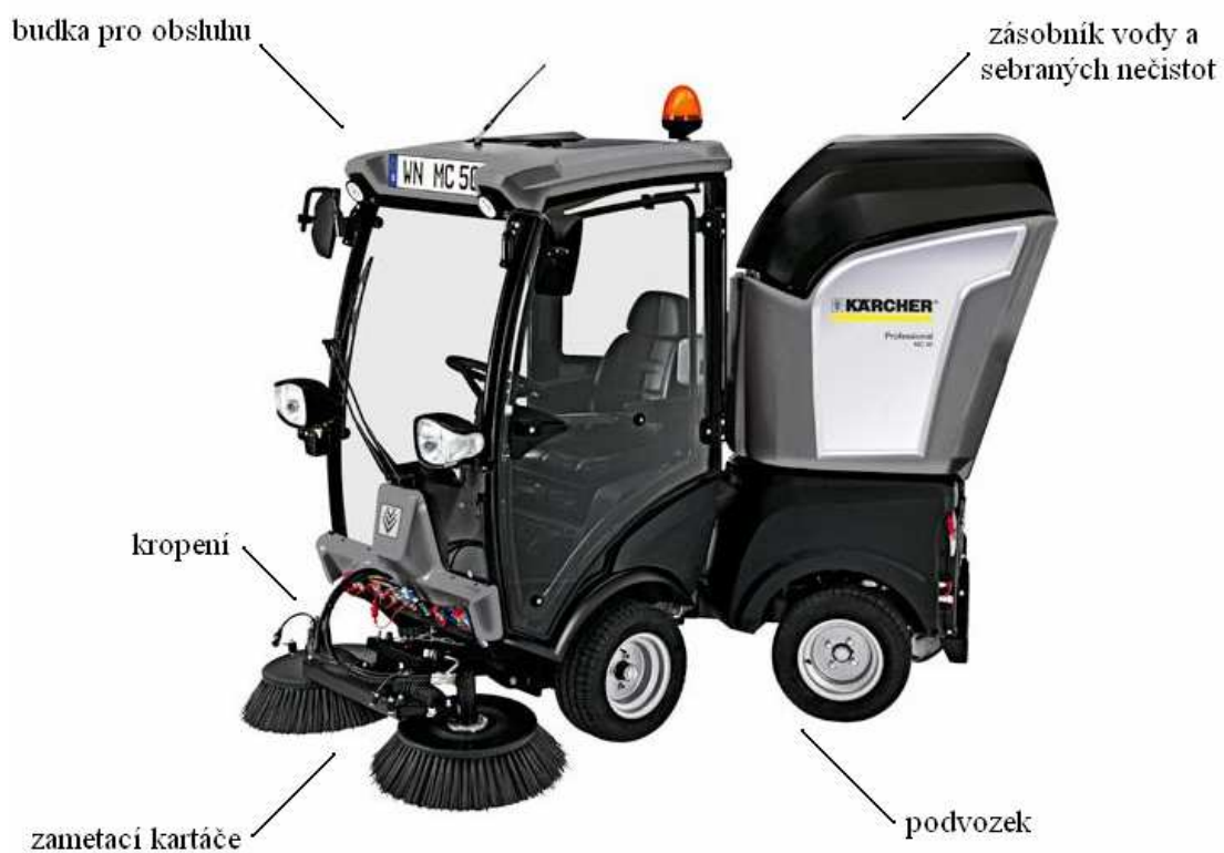
Obrázek 2.1.3 Jednouúčelový zametací stroj (karcher.cz [online] 2012)
