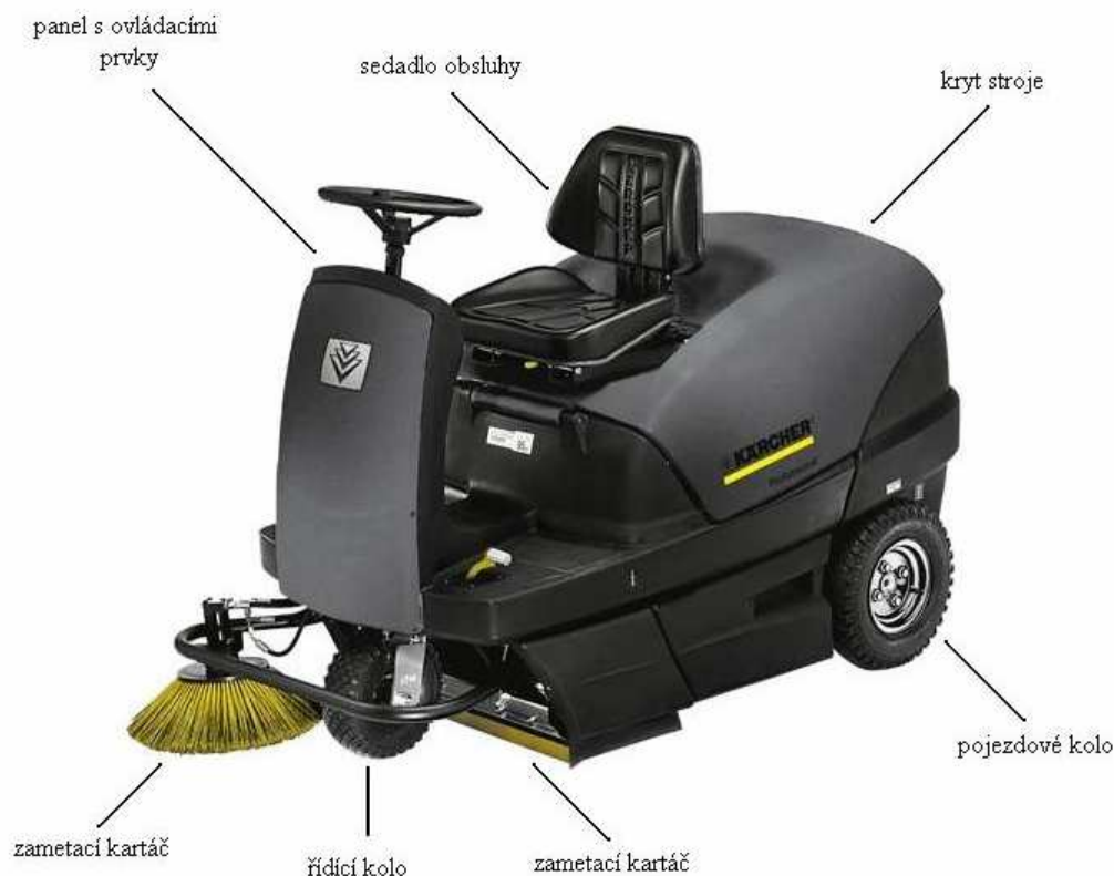
Obrázek 2.1.5 Zametačí stroj se sedící obsluhou (karcher.cz [online] 2012)
