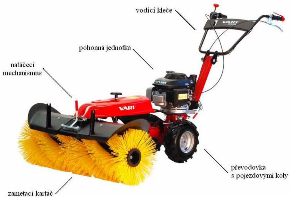
Obrázek 2.1.10 Zametací kartáč s pohonnou jednotkou ( vari.cz [online] 2012)
