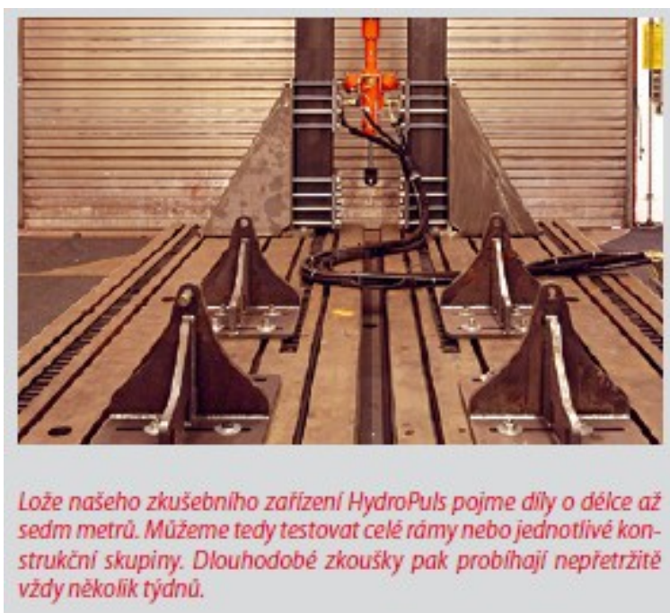
Obrázek 5.5 – Pohled na lože hydraulického testovacího stroje
