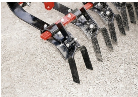
Obrázek 4.3 - smyk Crossboard s Double-Knife
