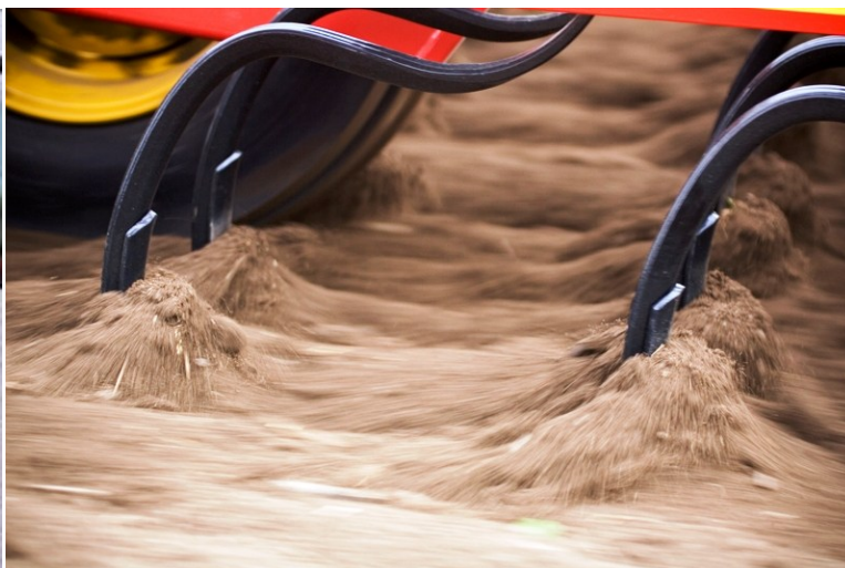
Obrázek 2.6 Práce pružných radliček stroje NZ Aggressive od firmy VÄDERSTAD
