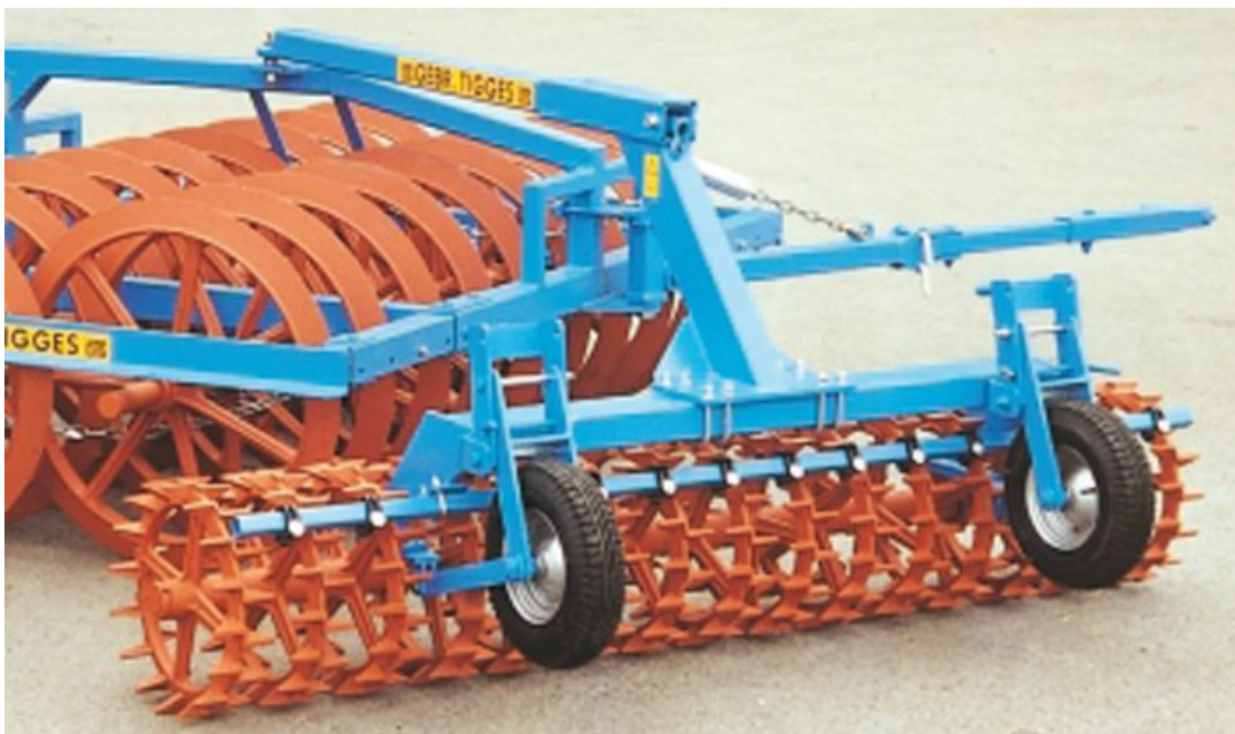
Obrázek 2.7 – dvojitý pěch s cross-kill válcem výrobce GEBR.TIGGES
