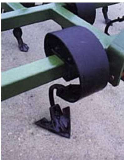
Obrázek 2.5 Pružná slupice s radličkou od firmy MOLČÍK
