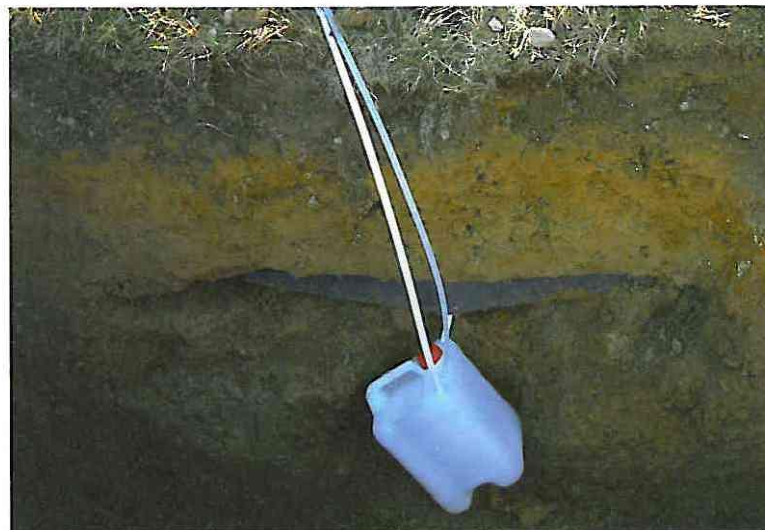
Obr. č. 8 Půdní profil s lyzimetrickou plochou pro zjišťování koncentrace živin v podzemních průsakových vodách.
