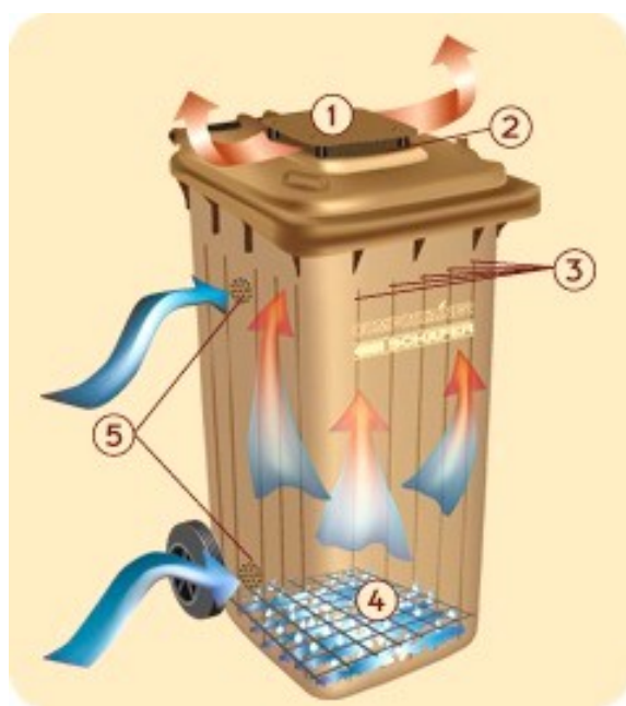
Obr. 1: Speciálně upravená nádoba na biologicky rozložitelný komunální odpad
