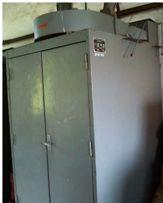
Fotografie č. 9: Sušící zařízení – Kovopodnik Broumov - rok výroby 1990, sušící teplota 50°C
