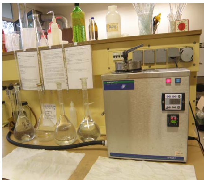
Fotografie č. 11: Přístroj ANKOM – Fiber Analyzer používaný ke stanovení vlákniny
