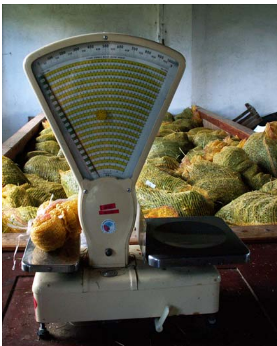
Fotografie č. 8: Váha použitá ke stanovení hmot. zelené a suché hmoty
