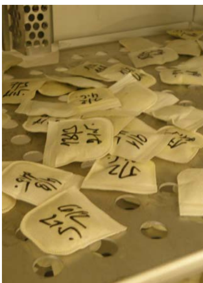
Fotografie č. 10: Vysoušení sáčků v sušárně při teplotě 105 °C
