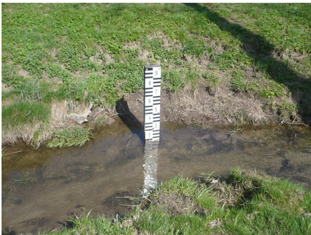
Příloha 6: Svislý vodočet v uzávěrovém profilu T7U
