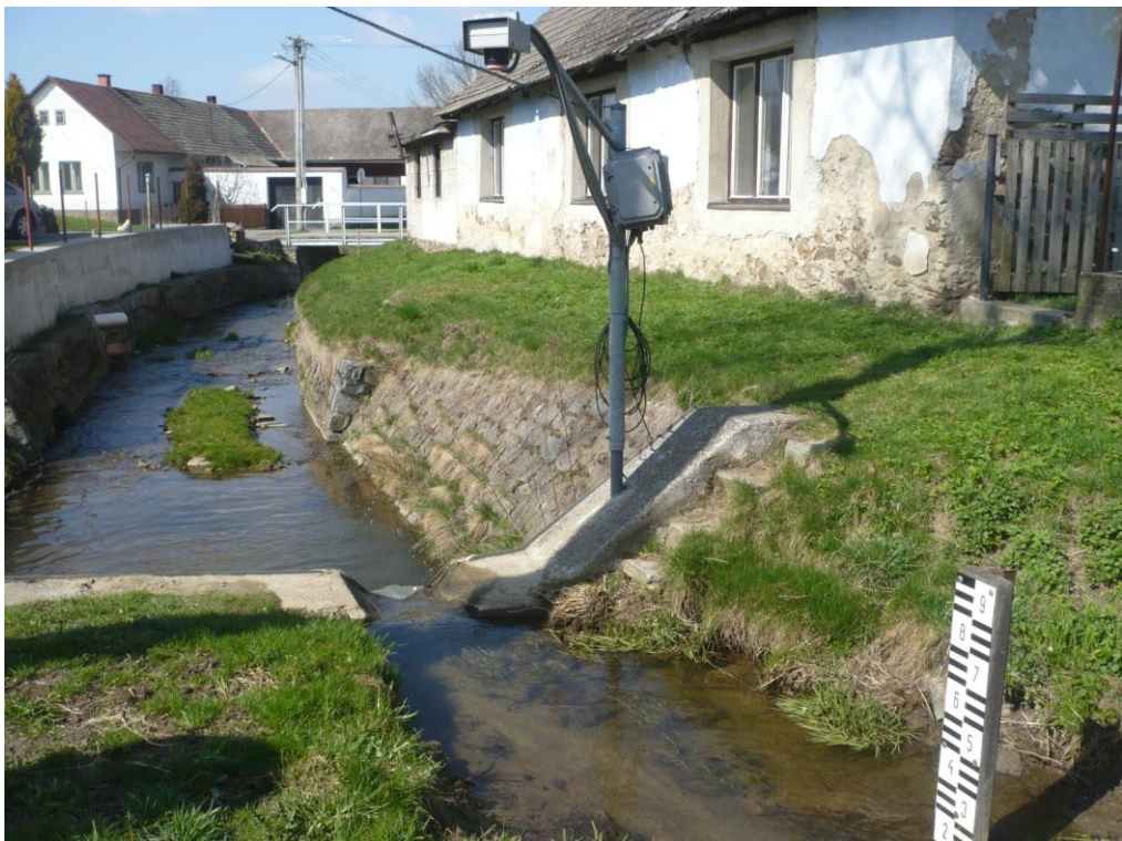
Příloha 5: Uzávěrový profil T7U – ultrazvukový snímač výšky hladiny vody
