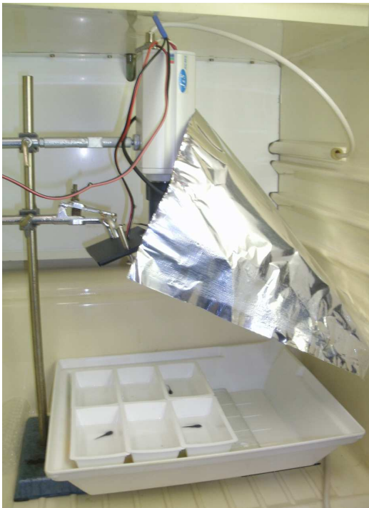
Obr. 1: Monitorovací zařízení. Šest arén s pulci, jejichž pohyb byl monitorován pomocí kamery a zaznamenáván v programu EthoVision.
