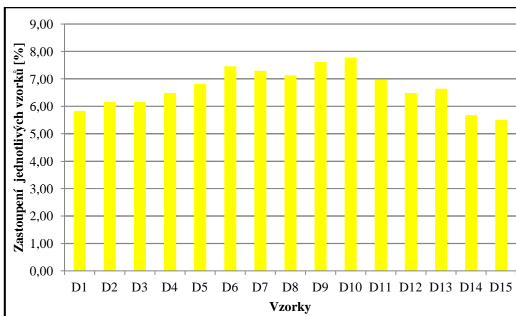
Graf 5 – Graficky znázorněná kvalita rozptýlu rostlinných zbytků pro New Holland CR 9080 při sklizni řepky o vlhkosti zrna 12,6 % (pole č. 6)
