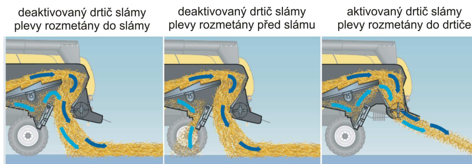
Obrázek 17 – Jednotlivé možnosti činnosti systému Dual - Chop
