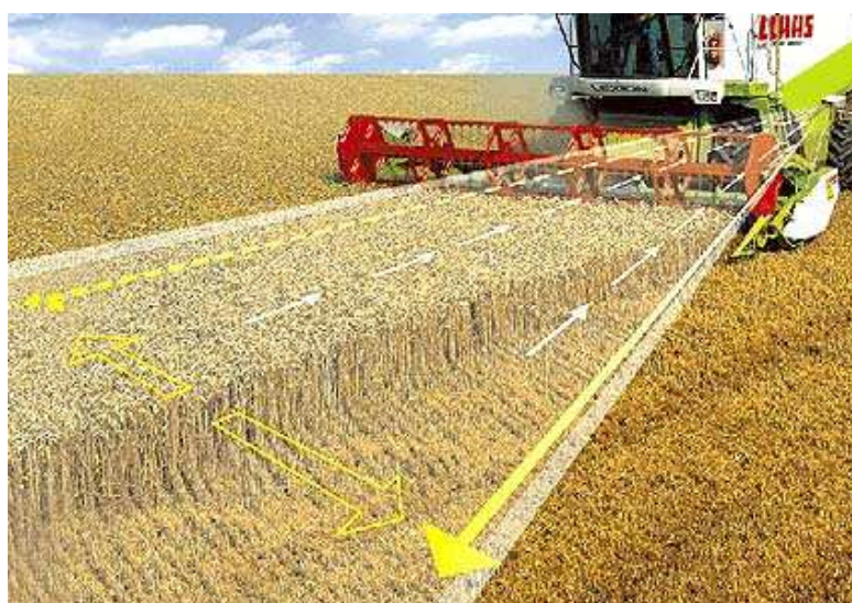
Obrázek 22 – Činnost systému Claas Laser Pilot
