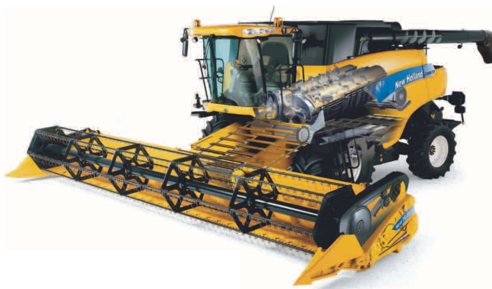
Obrázek 2 - Axiální sklízecí mlátička New Holland s technologií Twin Rotor
