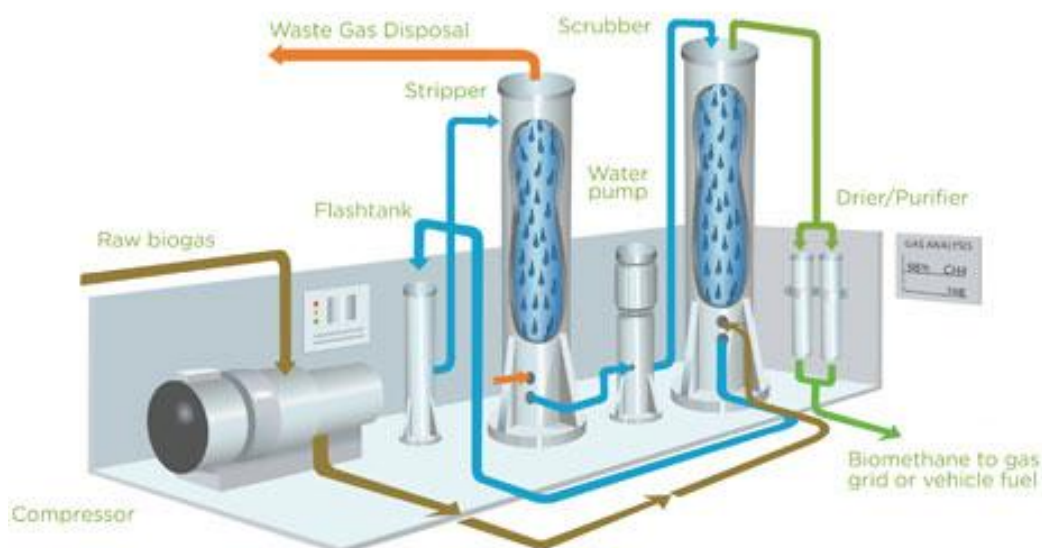
Obrázek č. 14: Schéma Tlaková vypírka, zdroj: Greenlane Biogas
