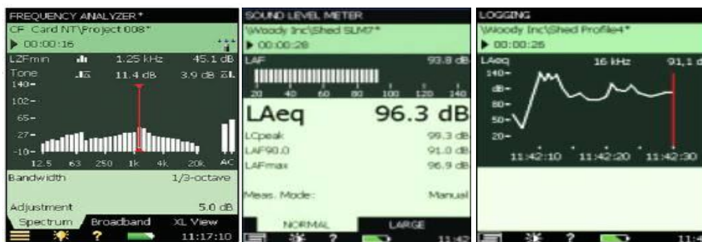
Obr. č. 17 – Příklad zobrazení displeje (frekvenční analýza, obecné hodnoty, časový záznam)[7]
