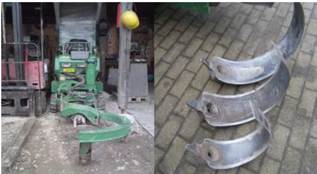
Obr. 6.4 Samojízdný přesazovací stroj Holmac HCZ29 detail ramene (Dohnalová, Sony Ericsson), a pracovních orgánů [9]
