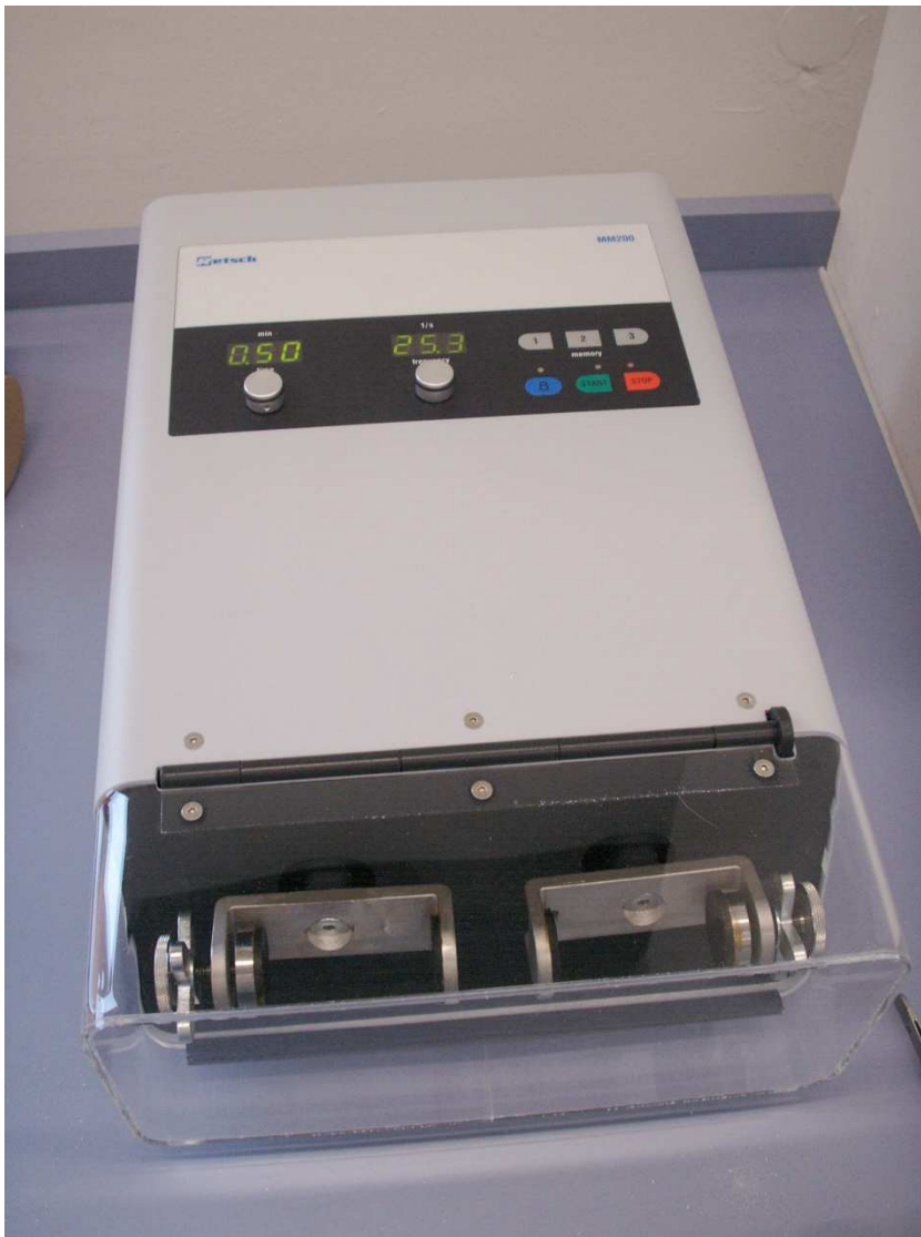
Přístroj na drcení kostí (MM 200, Retsch, Haan, Německo).
