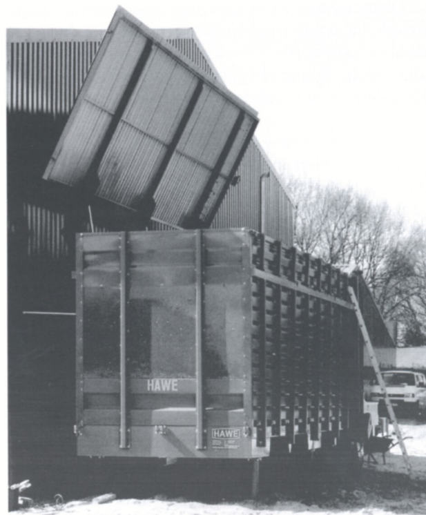
Obr. 31 Dávkovací zařízení s posuvnou podlahou
