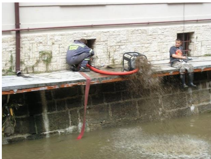
Obrázek 32 Kalové čerpadlo umístěné mimo čerpanou kapalinu [27]
