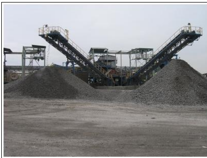
Obrázek 35 - Třídění struskového kameniva na jednotlivé frakce (6)
