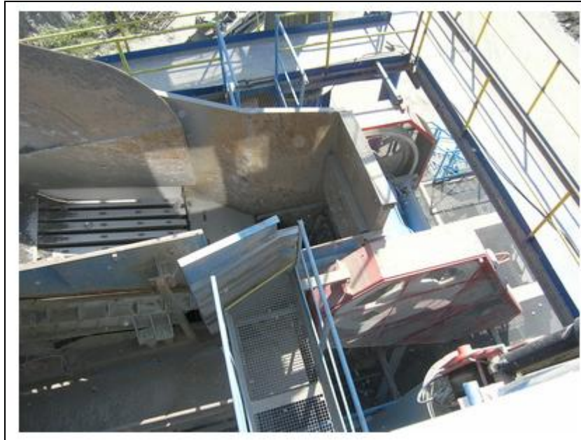
Obrázek 36 - Čelistový drtič s odhliňovačem (6)
