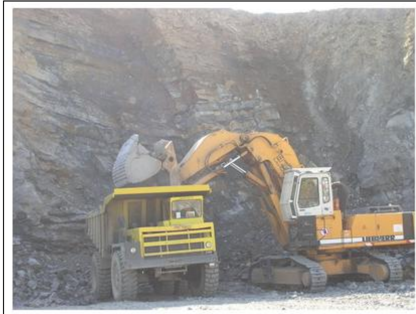
Obrázek 31 - Nakládka rozvalu - pásové rypadlo a dampr (6)
