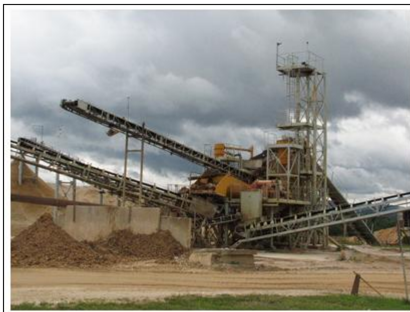
Obrázek 40 - Třídící linka pro výrobu těženého kameniva mokrým způsobem (6)
