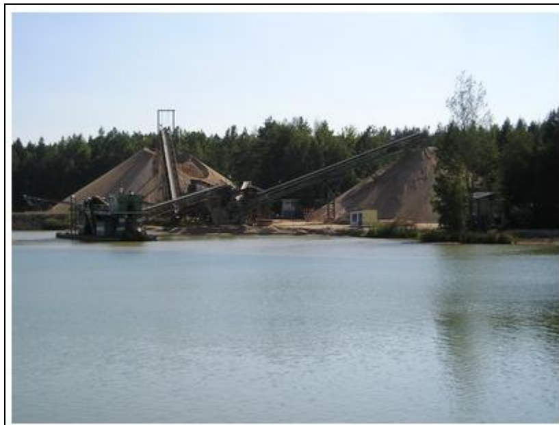
Obrázek 34 - Plovoucí korečkový elevátor (6)
