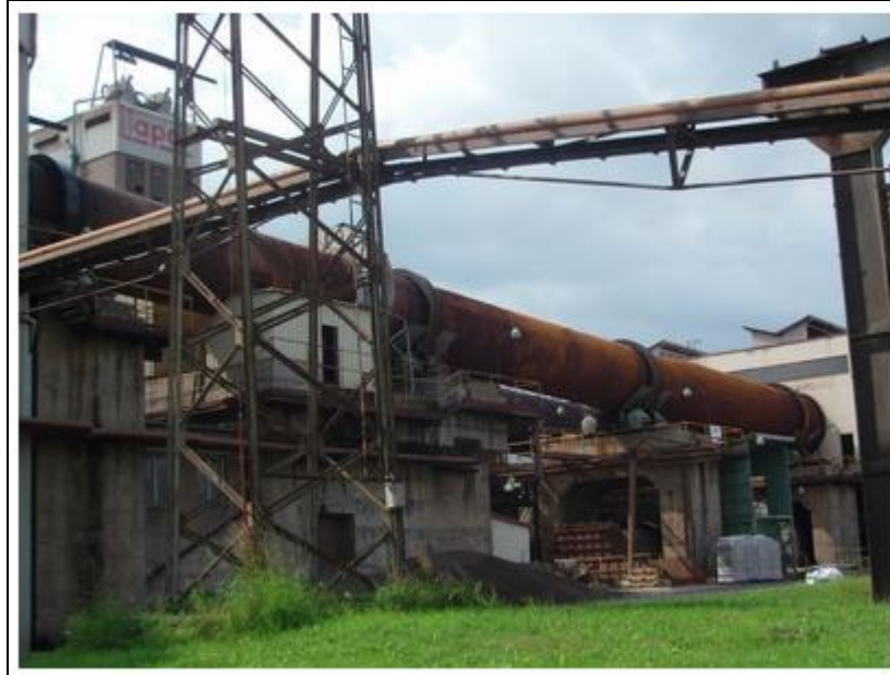
Obrázek 46 - Rotační pec pro výpal keramického kameniva (6)
