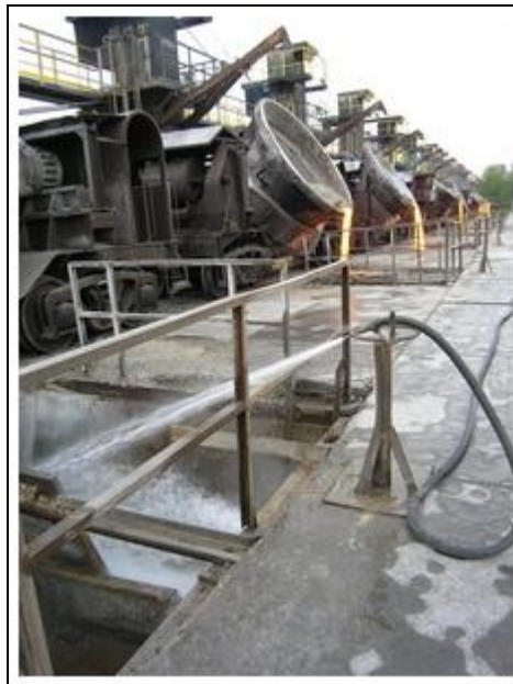
Obrázek 42 - Rychlé chlazení tekuté strusky vodou (6)
