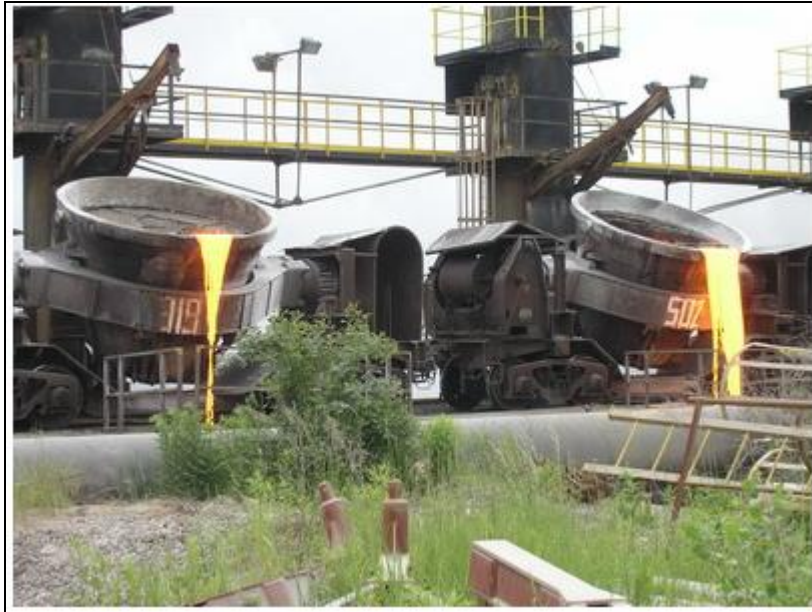
Obrázek 41 - Vylévání žhavotekuté strusky z kolib (6)
