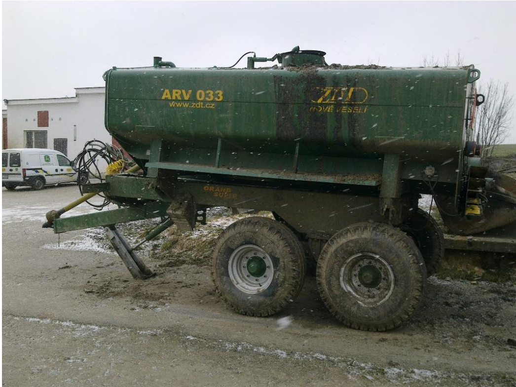
Obrázek 14 Rozmetadlo kejdy ARV 033 ZDT Nové Veselí
