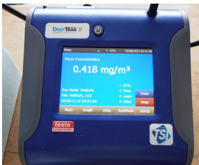
Obrázek 3. Přístroj DustTRAK 8530, na displeji přístroje lze okamžitě zjistit hodnoty koncentrace prachových částic
