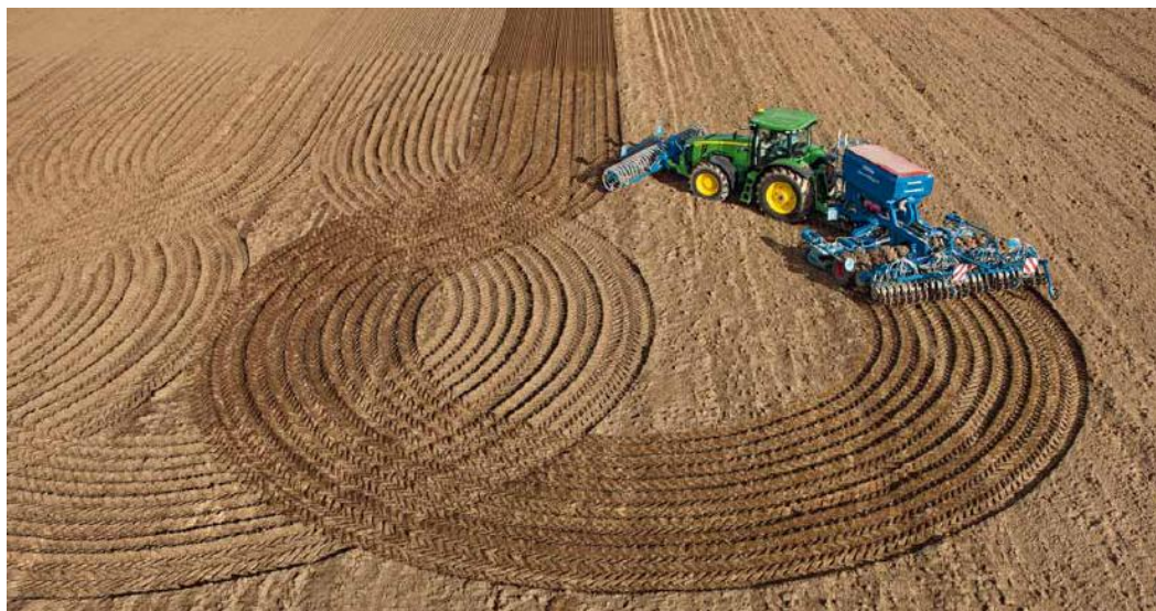
Obrázek 7: Plně automatické navádění při otáčení na souvratích
