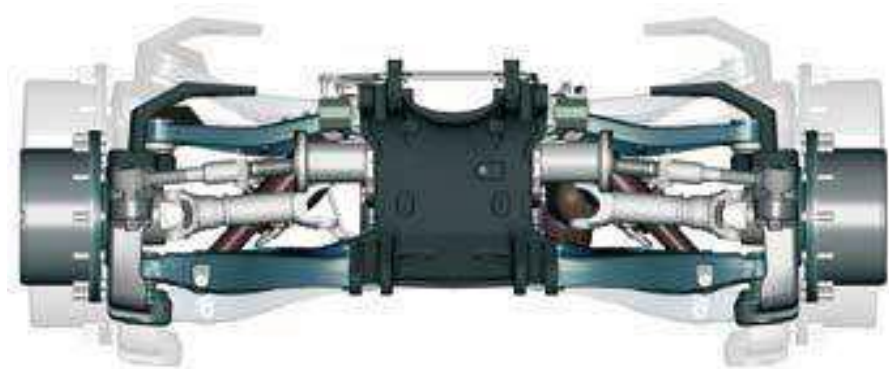
Obrázek 3 Nezávislé odpružení přední nápravy
