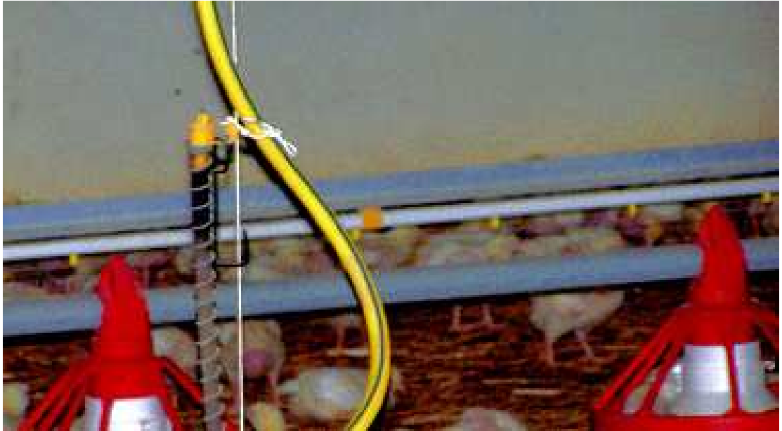
Obr. č. 9 Detailní pohled na technologické prvky pro krmení ustájených brojlerových kuřat – výškově nastavitelná automatická krmítka
