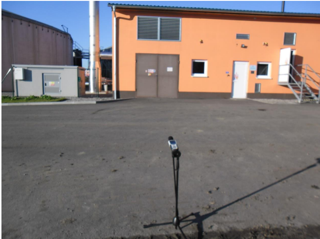
Obr. č. 8- První měřicí přístroj umístěn generátoru u bioplynové stanice v Olešníku
