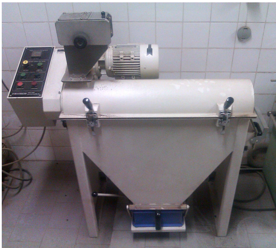
Obrázek č. 15: Půdní mlýn zn. Fritsch (foto autor, 17.12.2012)
