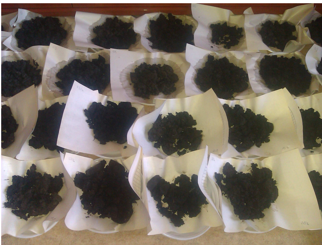
Obrázek č. 14: Sušení půdních vzorků (foto autor, 19.10.2012)
