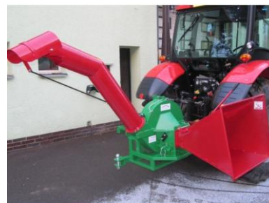
Obr. 7 Štěpkovač PIRBA pro dřevo do průměru 10 cm [29]
