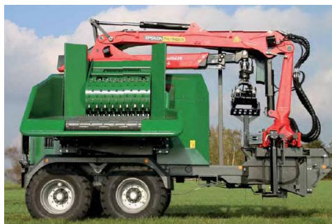
Obr. 8 Prívěsný štěpkovač JENZ HEM 820 zvládne dřevo do průměru 80 cm [27]
