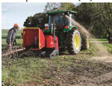
Obr. 6 Štěpkovač Linddana TP 160 PTO zpracovává větve a dřevní hmotu do průměru 16 cm [28]
