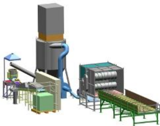
Obrázek 52 - Schéma peletizační linky 1000 Standart [49]
