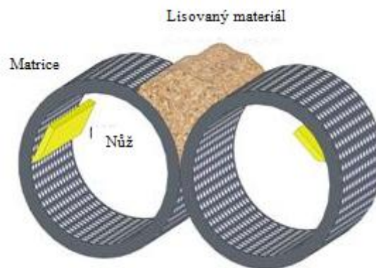
Obrázek 23 - Schéma peletovacího stroje Eco Tre Systém [20]
