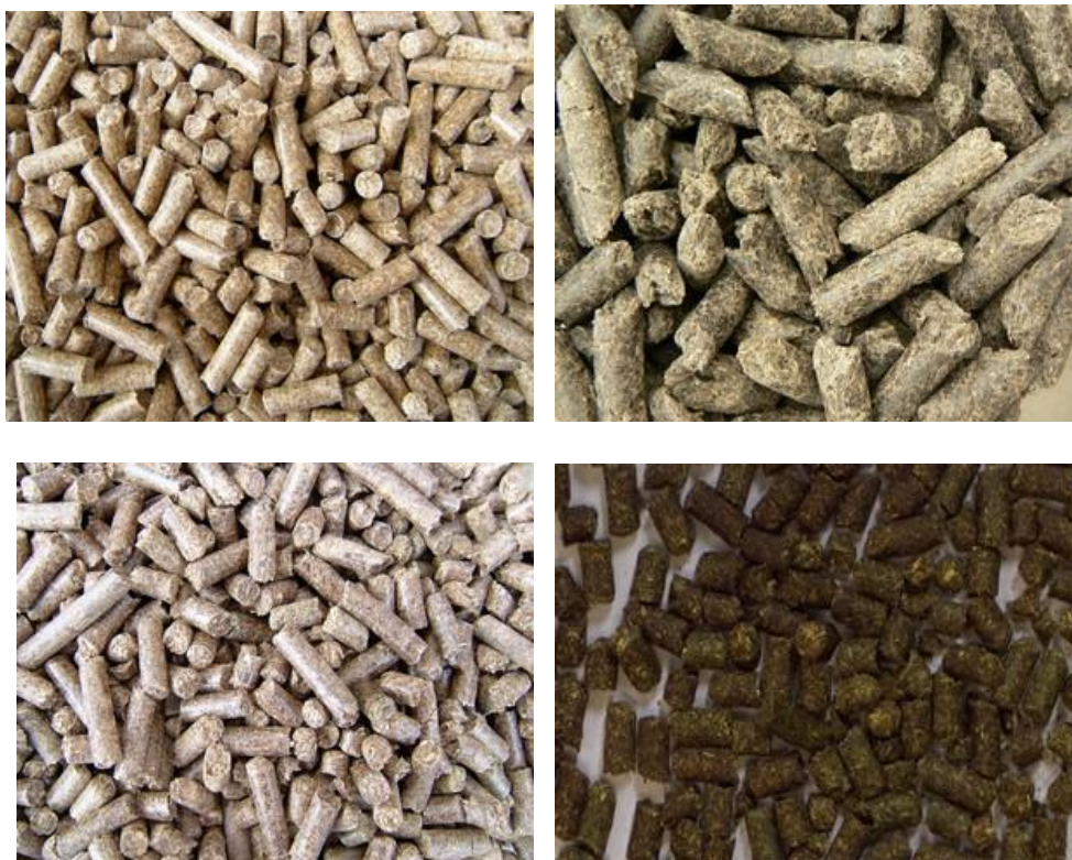
Obrázek 16 - Druhy pelet [3]: Pelety z řepkové slámy (vlevo nahoře), ze slunečnicové slámy (vpravo nahoře), ze šřovíku (vlevo dole), ze sena (vpravo dole)
