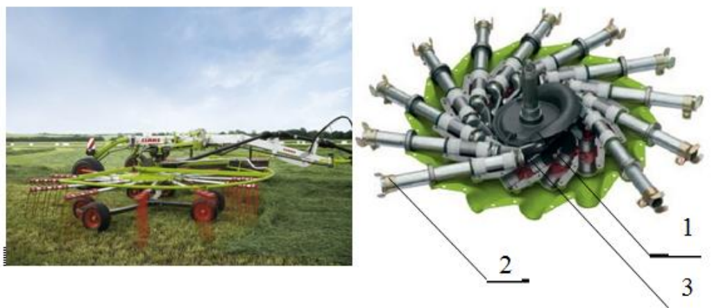
Obrázek 46 - Rotorový shrnovač se sklupnými vidlicemi [42]: 1 - vodící dráha, 2 - hřídel prstů, 3 - kliky
