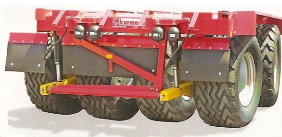
Obrázek 24 – Osmikolový podvozek Pöttinger [5]
