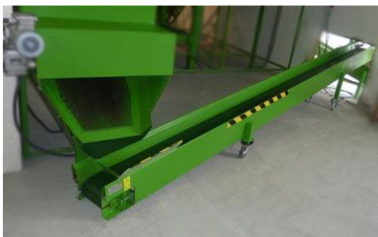
Obrázek 35 – Chladicí a separační dopravník [19]
