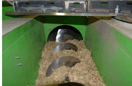
Obrázek 33 – Šnekový dávkovací dopravník [19]
