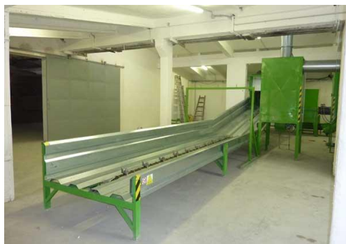
Obrázek 31 - Podávací dopravník linky LPS 1800 [19]
