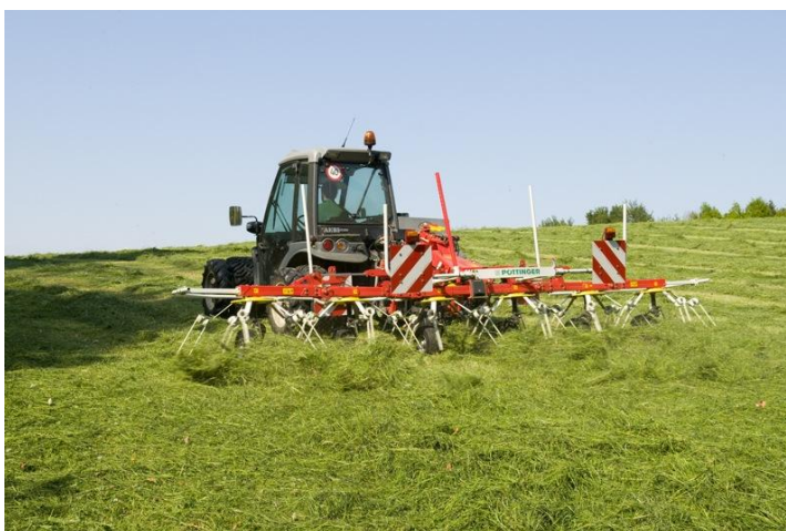
Obrázek 26 – Obraceč Pöttinger ALPINHIT 4.4 N nesený nosičem nářadí AEBI Terratrac TT 220 [5]
