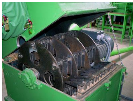
Obrázek 32 - Rotační drtič biomasy [19]
