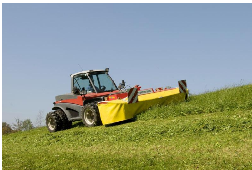
Obrázek 25 – Multifunkční nosič zařízení Aebi Terratrac TT 220 s čelní žací lištou Pöttinger NOVAALPIN 221 B [5]
