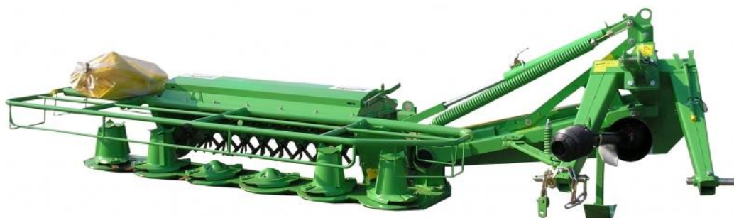
Obrázek 20 - Nesená disková žací lišta Samasz KDT 260 [14]
