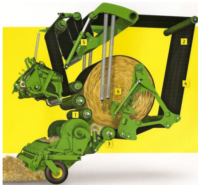
Obrázek 14 – Hlavní pracovní části lisu John Deere 960 [8]
