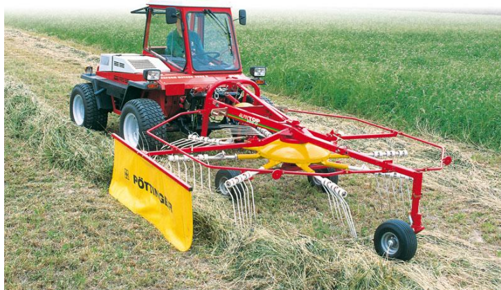
Obrázek 27 – Shrnovač Pöttinger ALPINTOP 300 U nesený nosičem nářadí AEBI Terratrac [5]
