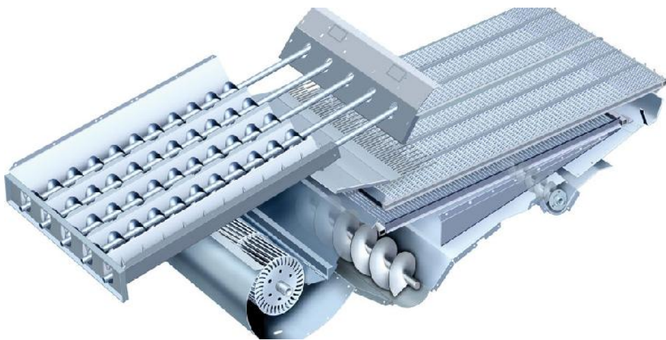
Obrázek II-G Čisticí systém u mlátiček Case IH
