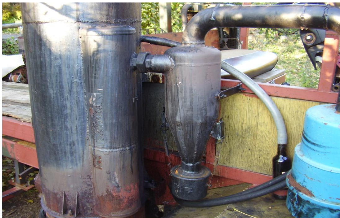
Obrázek 4.10 Použití cyklonu pro odprášení generátorového plynu
