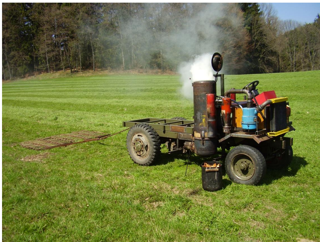
Obrázek 5.1 Měřené zařízení v rané fázi vývoje při prvních praktických zkouškách (jarní smykování pastvin)
