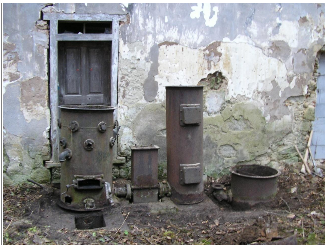
Obrázek 2.1 Pozůstatky generátorového zařízení - Hanzův mlýn nedaleko Trhových Svinů - provozováno mezi lety 1928 - 1936. generátorová souprava firmy Wikov. foto 2011
