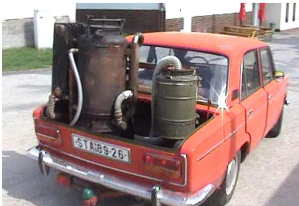
Obrázek 2.2 Ukázka nelegální přestavby vozidla na pohon dřevoplynem. Lada 2103 - 1500ccm, maximální rychlost 70km/h, spotřeba 50-60 kg dřeva/100km.
