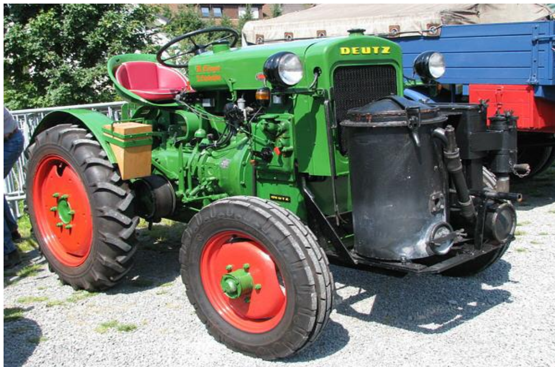
Obrázek 2.3 Přestavba traktoru Deutz (generátor typu Imbert). Převzato z [7]
