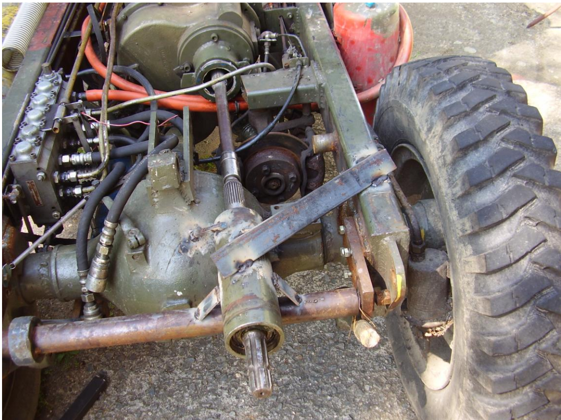
Obrázek 5.7 Narychlo zhotovený zadní vývodový hřídel
