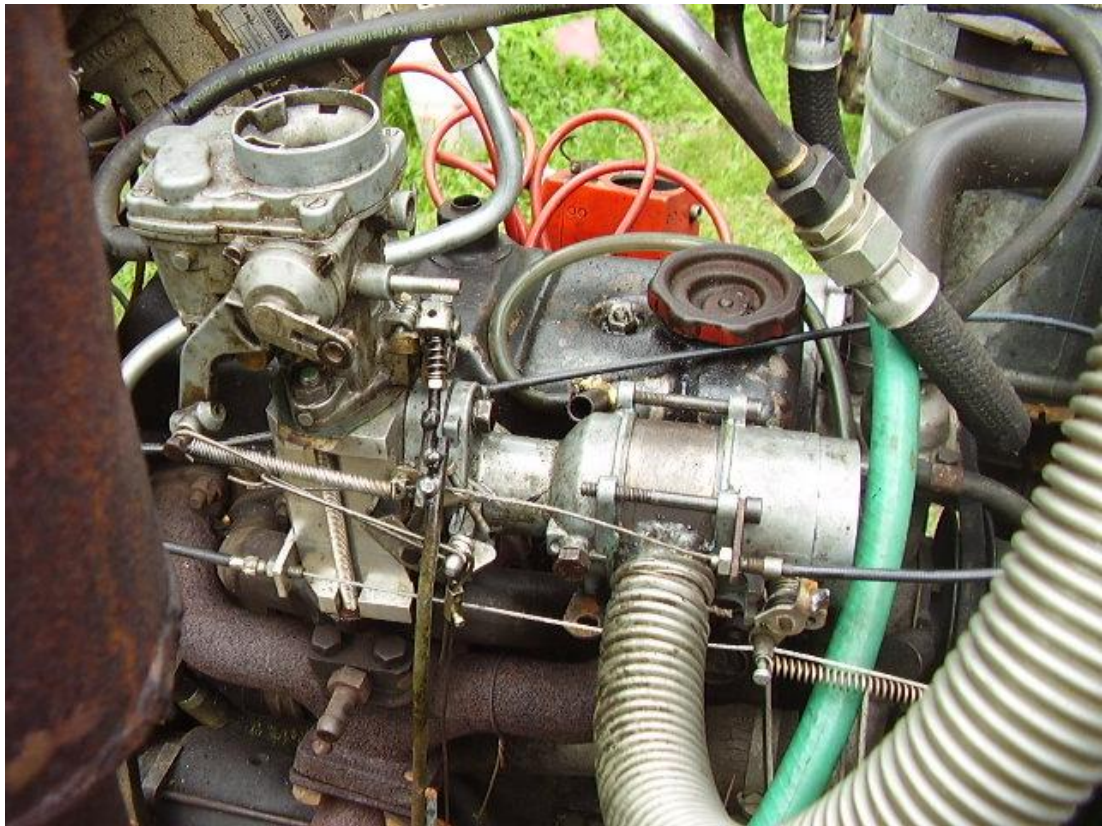
Obrázek 4.13 Nepříliš zdařilá přestavba motoru škoda 1203 (příliš mnoho zúžených průřezů a ostrých ohybů).
