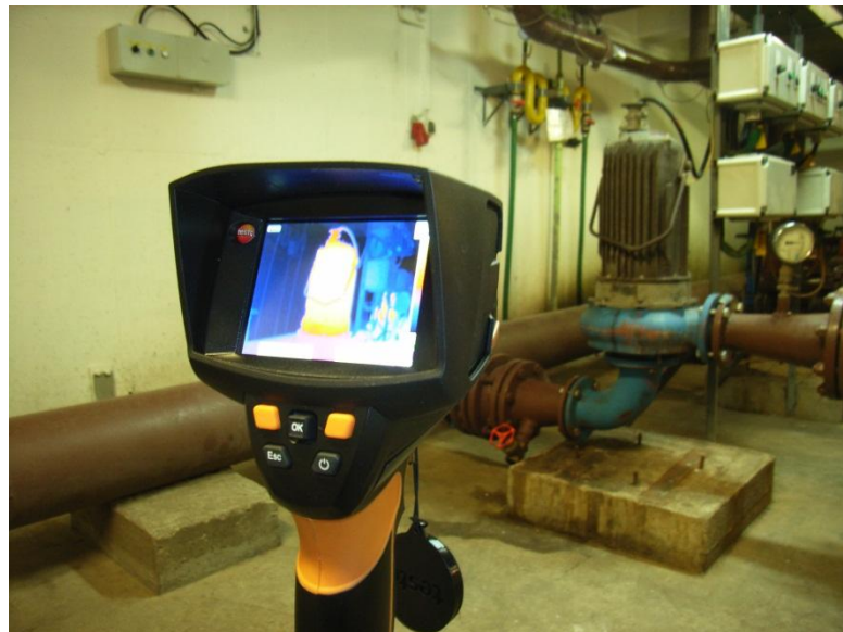
Obrázek 3.1: Termokamera Test 875 při měření (foto: autor)
