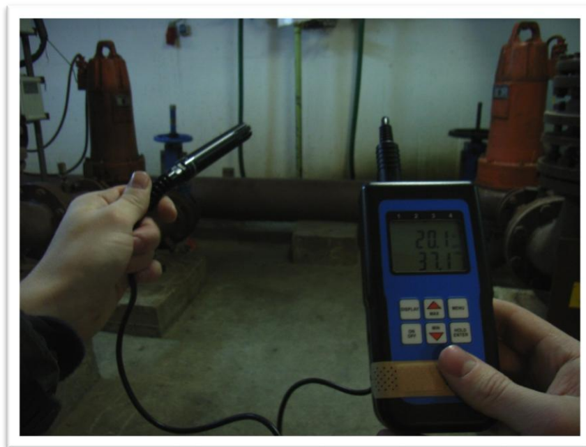
Obrázek 3.2: Teploměr-vlhkoměr Comet D3121 při měření (foto: autor)
